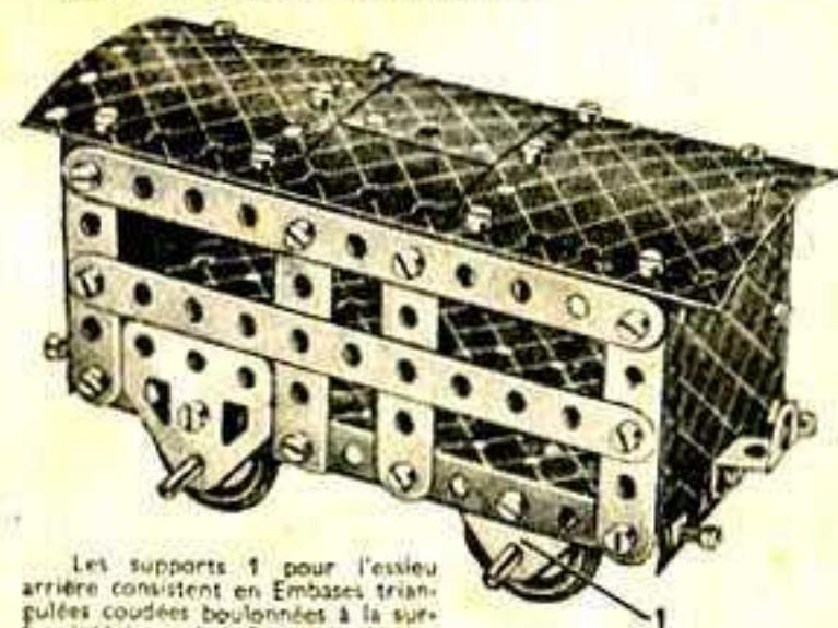
Les supports 1 pour l'essieu arrière consistent en Embases triangulées coulées boulonnées à la surface intérieure de la Plaque à rebords. L'autre côté du wagon est construit exactement de la même façon que celui représenté sur le cliché.
