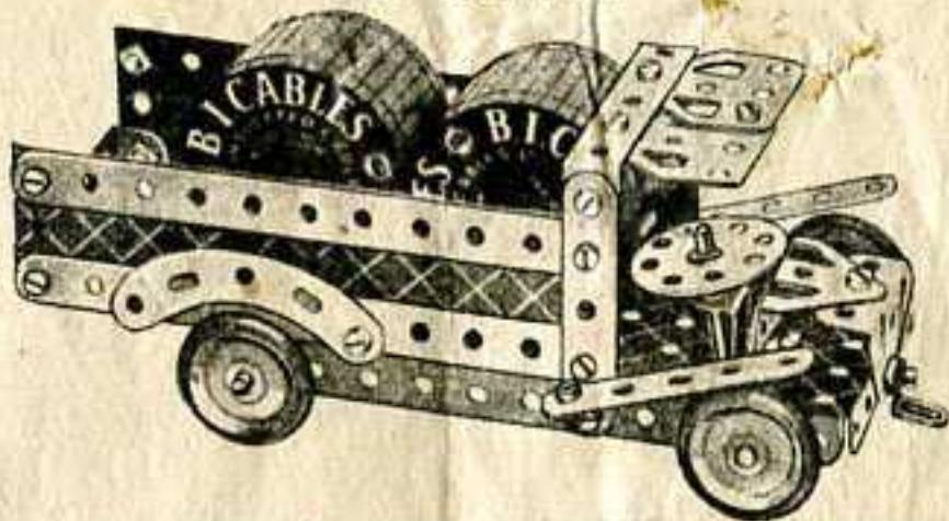
Chacune des bandes incurvées de 6 cm., représentant les garde-boue arrière est fixée au côté du camion par un boulon de 9 mm. et un écrou. Une clovette placée sur le boulon sert à écartier chaque garde-boue de la paroi du camion.
