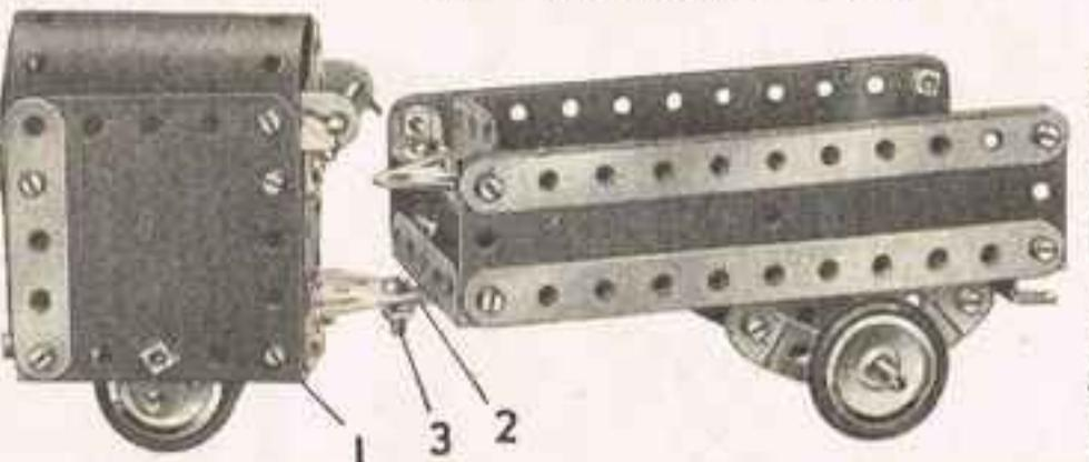
Chaque côté du tracteur consiste en une plaque flexible de 6 x 6 cm. boulonnée à une bande coudée 1. Une plaque flexible de 11,5 x 6 cm. est incurvée et fixée de chaque côté pour former le capot. L'avant et l'arrière sont remplis par une plaque flexible de 6 x 4 cm. et une embase triangulée plate. L'essieu avant passe dans deux supports plats.
