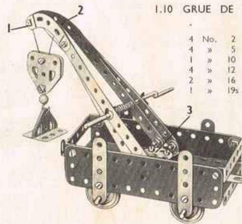
La corde de levage est attachée à la manivelle et passée par-dessus le boulon de 9,5 mm. (1). Passée ensuite autour du palan, elle est attachée à la flèche en 2. La flèche est reliée à la roue barillet au moyen d'équerres et l'ensemble est articulé de la façon suivante : un boulon de 9,5 mm. est passé à travers la plaque à rebords de 14 X 6 cm. et est fixé dans le moyeu de la roue barillet par sa vis d'arrêt.
