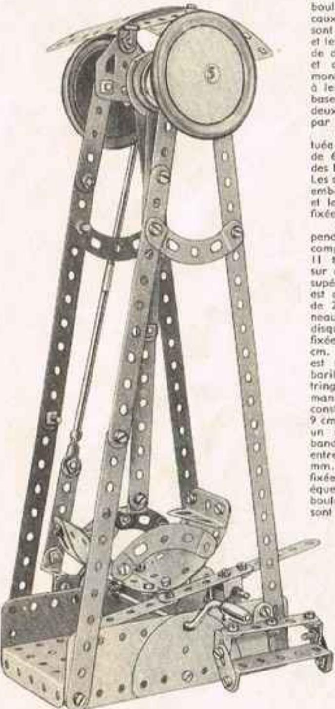
La base du modèle est formée par une plaque à rebords sur laquelle sont boulonnés les montants verticaux. Deux des montants sont des bandes de 25 trous et les deux autres sont formés de deux bandes de 11 trous et d'une de 5 trous. Les montants sont joints par deux à leur sommet par une embase triangulaire plate et les deux embases sont réunies par une bande coudeée 1.
