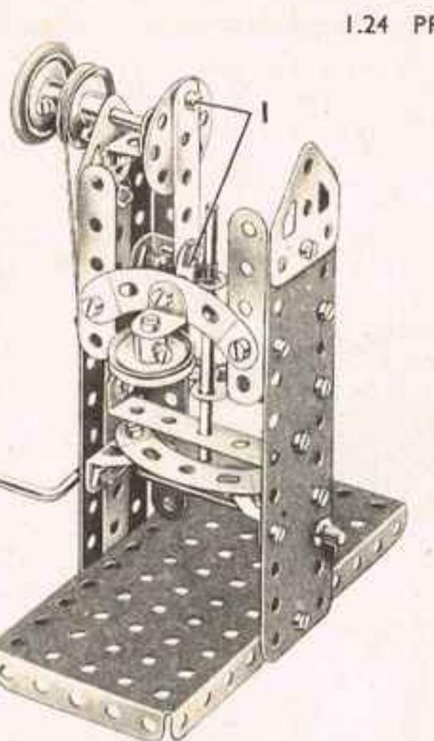
Les boulons 1 sont munis de contre-écrous et l'équerre située à l'extrémité inférieure de la bande de 6 cm. est pourvue d'une tringle de 11 cm. 5 insérée dans son trou allongé où elle est maintenue à l'aide de deux clavettes.
