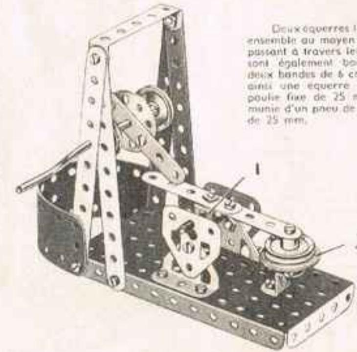
Deux équerres 1 sont reliées ensemble au moyen de boutons passant à travers leurs trous et sont également boulonnées à deux bandes de 6 cm., formant ainsi une équerre double. La poule fixe de 25 mm. (2) est munie d'un pneu de caoutchouc de 25 mm.
