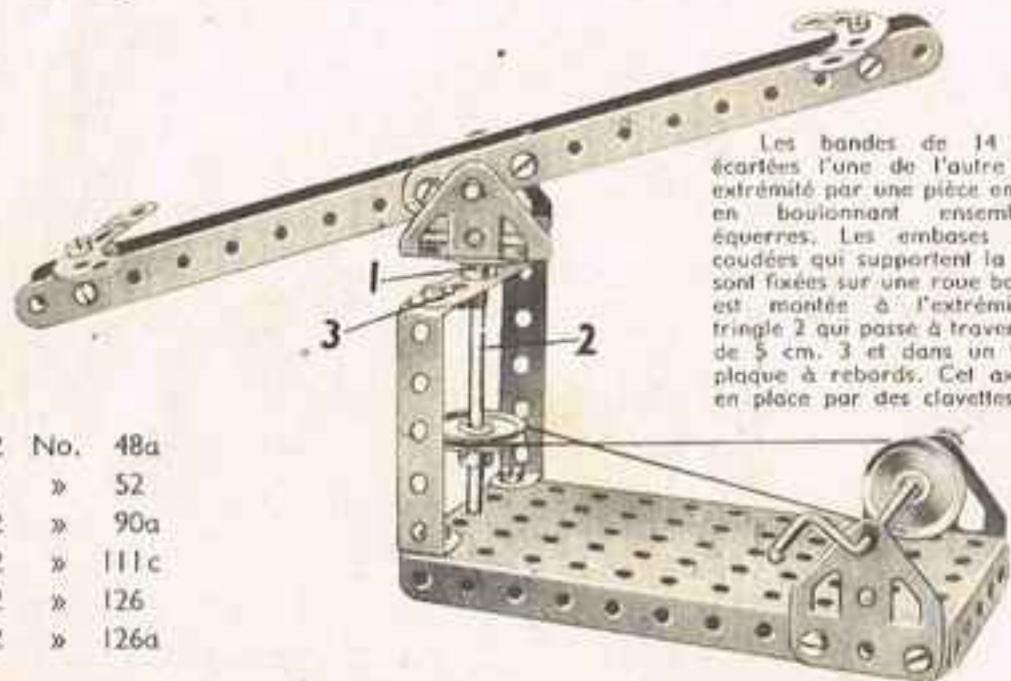
Les bandes de 14 cm. sont écartées l'une de l'autre à chaque extrémité par une pièce en U formée en boulonnant ensemble deux équerres. Les embases triangulées coudées qui supportent la balançoire sont fixées sur une roue barillet 1 qui est montée à l'extrémité de la tringle 2 qui passe à travers la bande de 5 cm. 3 et dans un trou de la plaque à rebords. Cet axe est tenu en place par des clavettes.
