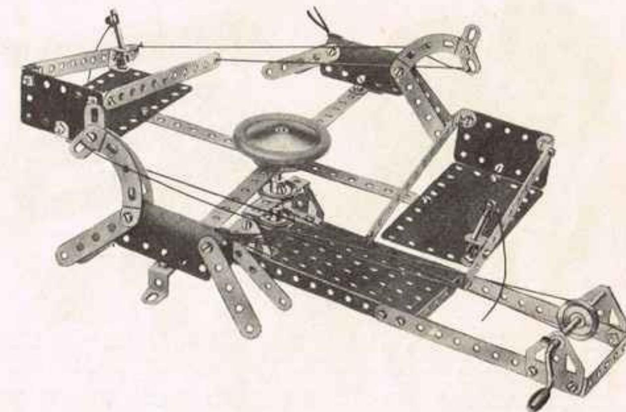
Les deux chevaux et les deux voitures sont fixés aux extrémités de deux bandes de 25 trous boulonnées à angle droit l'une de l'autre à une roue bâillet fixée sur une tringle verticale de 9 cm. Cette tringle passe dans une bande coulée de  $60 \times 12$  mm., et dans un des trous de la plaque à rebords formant la base.
