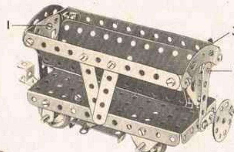
Les boulons 1 sont munis de contre-écrous. Une corde est attachée à la tringle 2 (fig. 1.7a), enroulée deux ou trois fois autour d'elle, passée ensuite à travers le trou de la plaque à rebords au-dessus de la tringle et fixée à l'équerre 3. En tournant la roue barillet, on fait basculer le wagon.
