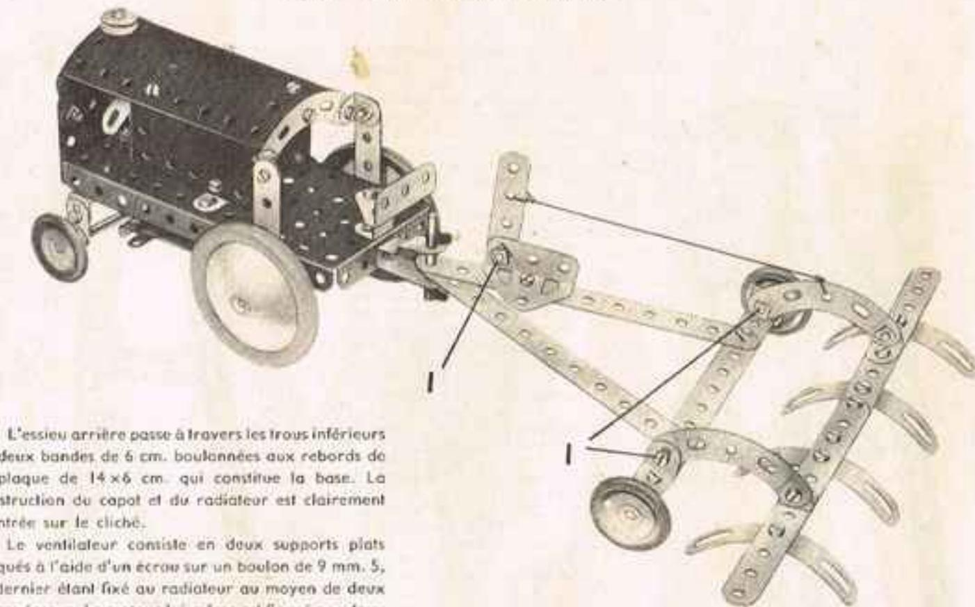
L'essieu arrière passe à travers les trous inférieurs de deux bandes de 6 cm. boulannées aux rebords de la plaque de 14 x 6 cm. qui constitue la base. La construction du capot et du radiateur est clairement montrée sur le cliché.
