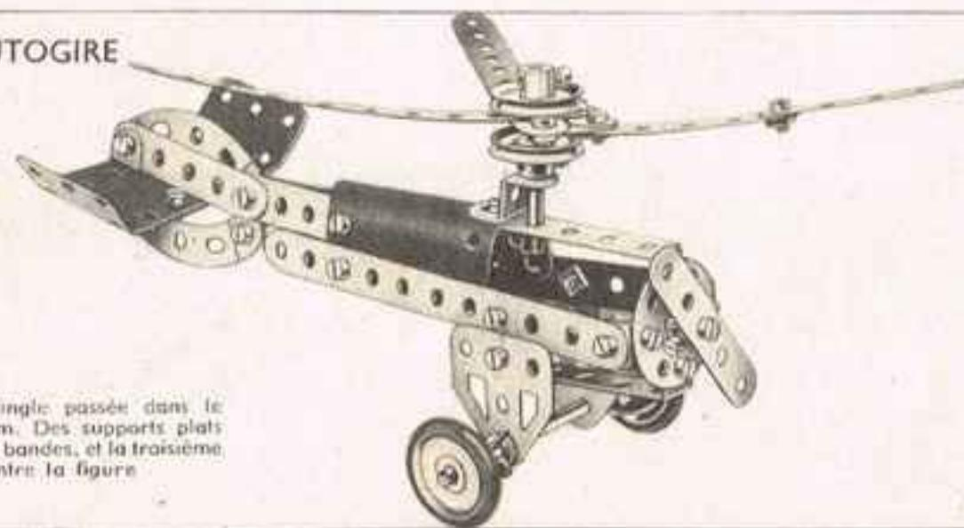
Le rotor est constitué par une tringle passée dans le deuxième trou de deux bandes de 9 cm. Des supports plats sont boulonnés aux extrémités courtes des bandes, et la troisième aile du rotor y est fixée comme le montre la figure.
