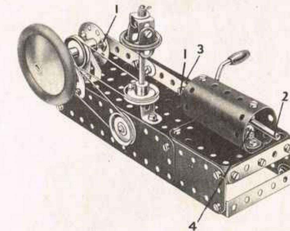
Une embase triangulaire plate et une embase triangulaire coudée servent de supports à la tringle figurant le vilebrequin. Ce dernier porte à l'une de ses extrémités une roue et une poulie de 25 mm. et est muni à l'autre bout d'une deuxième poulie de 25 mm. située entre les supports et une roue barillet.
