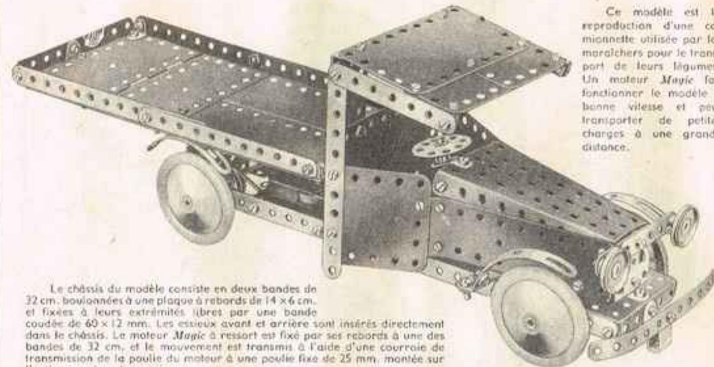
Le châssis du modèle consiste en deux bandes de 32 cm. boulonnées à une plaque à rebords de 14 x 6 cm. et fixées à leurs extrémités libres par une bande coulée de 60 x 12 mm. Les essieux avant et arrière sont insérés directement dans le châssis. Le moteur Magic à ressort est fixé par ses rebords à une des bandes de 32 cm. et le mouvement est transmis à l'aide d'une courroie de transmission de la poulie du moteur à une poulie fixe de 25 mm. montée sur l'essieu arrière du camion.
