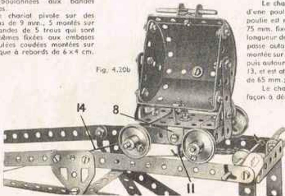
Le chariot est mis en mouvement par une manivelle munie d'une poule de 25 mm. 9 (Fig. 4.20a). Cette poule est reliée par une corde à une poule de 75 mm. fixée sur une tringle de 10 cm. 10. Une longueur de corde fixée à la chape 11 (Fig. 4.20b), passe autour d'une seconde poule de 75 mm. montée sur la tringle 10, ensuite sous la tringle 12, puis autour d'une poule de 12 mm. sur la tringle 13, et est attachée à une courroie de transmission de 65 mm.; cette courroie est fixée sur la chape.
