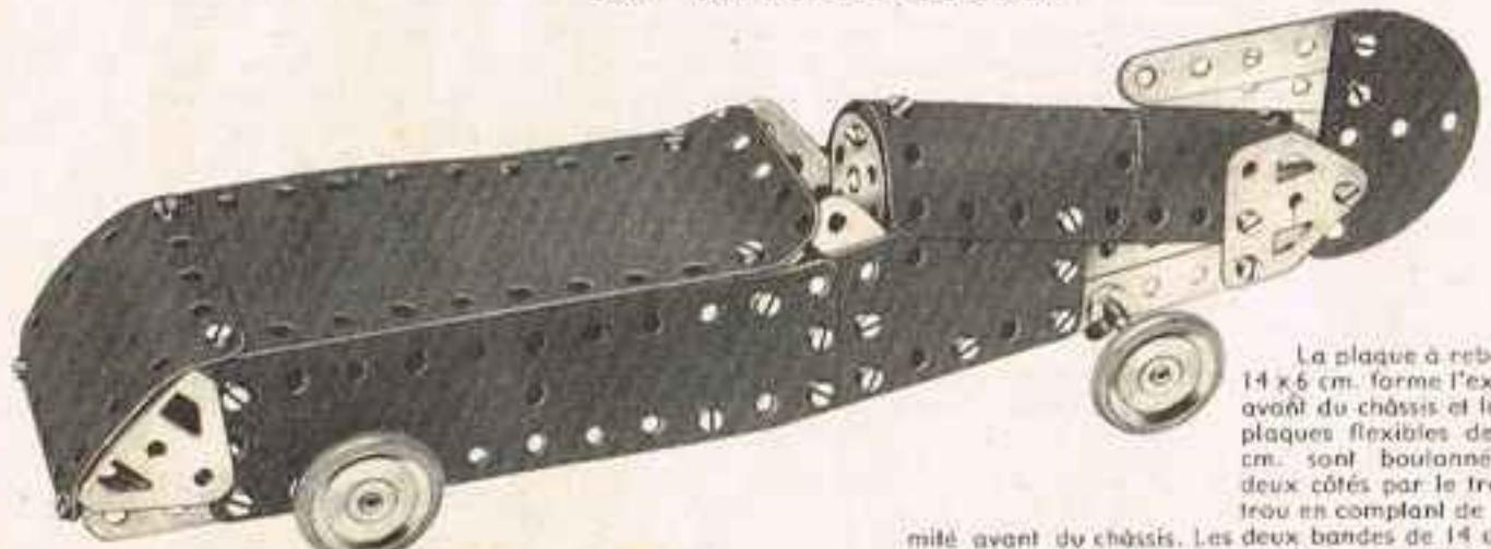
La plaque à rebords de 14 x 6 cm. forme l'extrémité avant du châssis et les deux plaques flexibles de 14 x 6 cm. sont boulonnées des deux côtés par le troisième trou encomplant de l'extrême-
