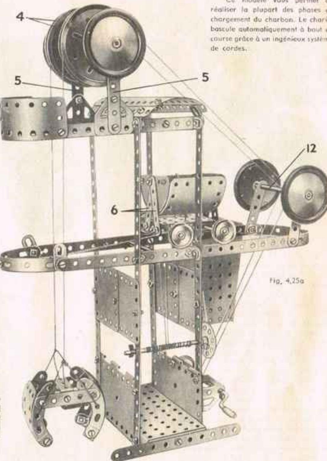
Ce modèle vous permet de réaliser la plupart des phases de chargement du charbon. Le chariot bascule automatiquement à bout de course grâce à un ingénieux système de cordes.
