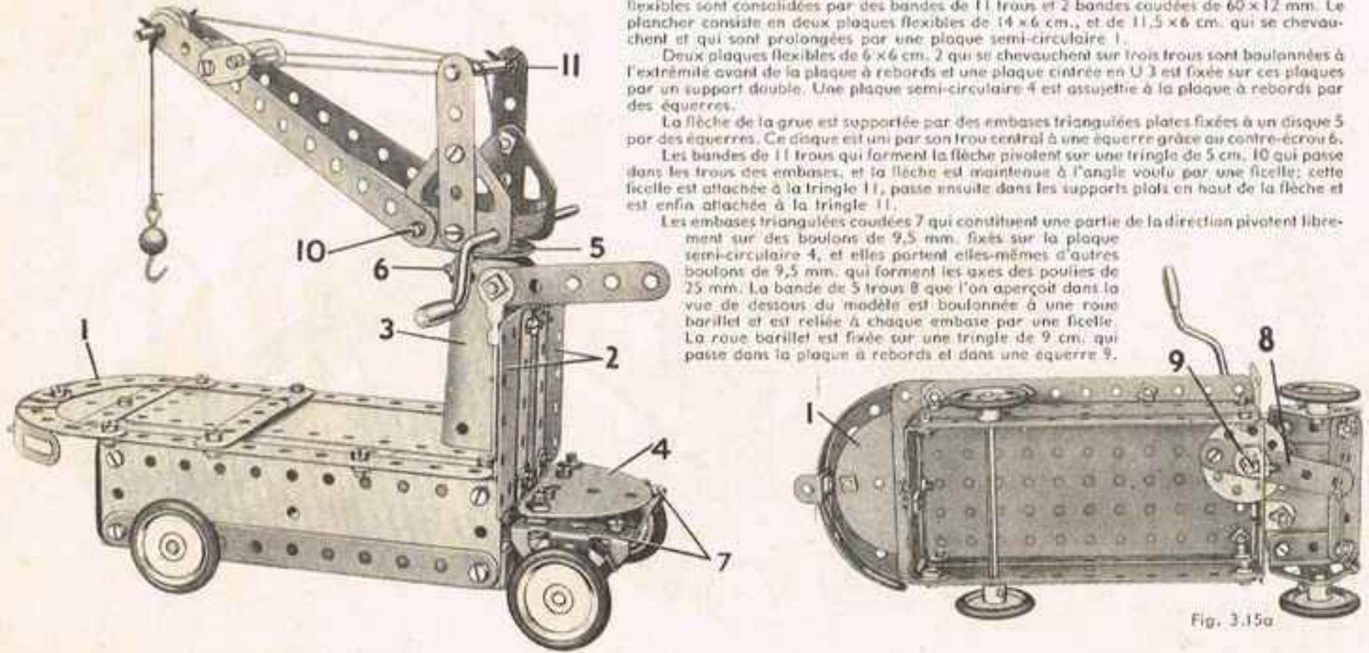
Le chariot électrique est construit d'abord en boulonnant une plaque flexible de  $6 \times 4$  cm. et deux de  $14 \times 4$  cm. aux côtés d'une plaque à rebords. A leur extrémité inférieure, les plaques flexibles sont consolidées par des bandes de 11 trous et 2 bandes coudées de  $60 \times 12$  mm. Le plancher consiste en deux plaques flexibles de  $14 \times 6$  cm., et de  $11,5 \times 6$  cm. qui se chevauchent et qui sont prolongées par une plaque semi-circulaire 4.
