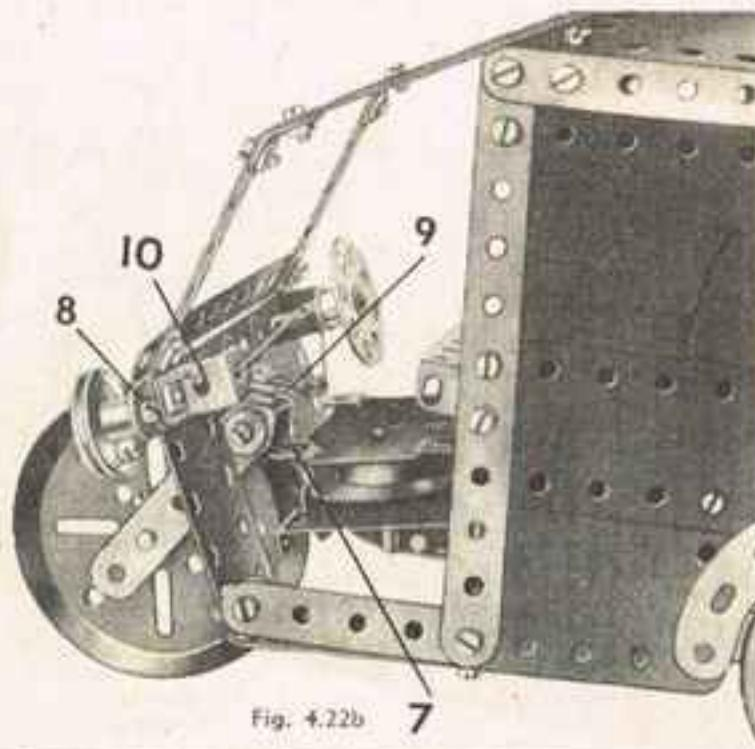
Une roue barillet représentant le volant est fixée sur une tringle de  $4$  cm. qui passe dans une équerre renversée et dans la bande 8. Une extrémité d'une longueur de corde est fixée au support plat 9, passe plusieurs fois autour de la tringle de  $4$  cm., passe ensuite dans l'équerre renversée 10, et est solidement fixée au support plat.
