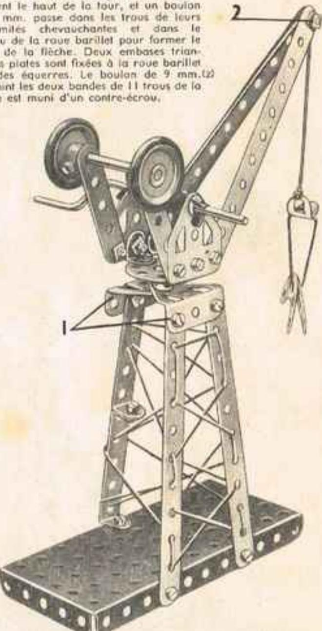
Deux embases triangulées coudées 1 forment le haut de la tour, et un boulon de 9 mm. passe dans les trous de leurs extrémités chevauchantes et dans le moyeu de la roue barillet pour former le pivot de la flèche. Deux embases triangulées plates sont fixées à la roue barillet par des équerres. Le boulon de 9 mm. (2) qui joint les deux bandes de 11 trous de la flèche est muni d'un contre-écrou.
