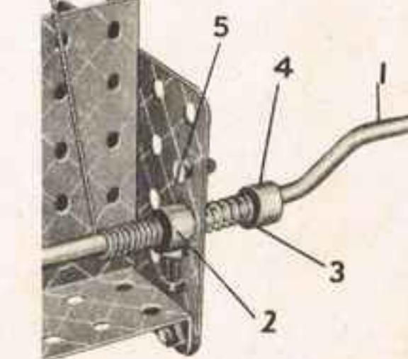
Le ressort de compression 3 est monté sur la manivelle 1 entre le collier 4 et une rondelle métallique, et maintient la bague d'arrêt 2 contre le côté intérieur de la plaque. Le collier 2 est muni d'un boulon de 9,5 mm. Si la manivelle commence à tourner, la tête de ce boulon frappe contre l'arrêt 5 et interdit le déroulement de la corde.
