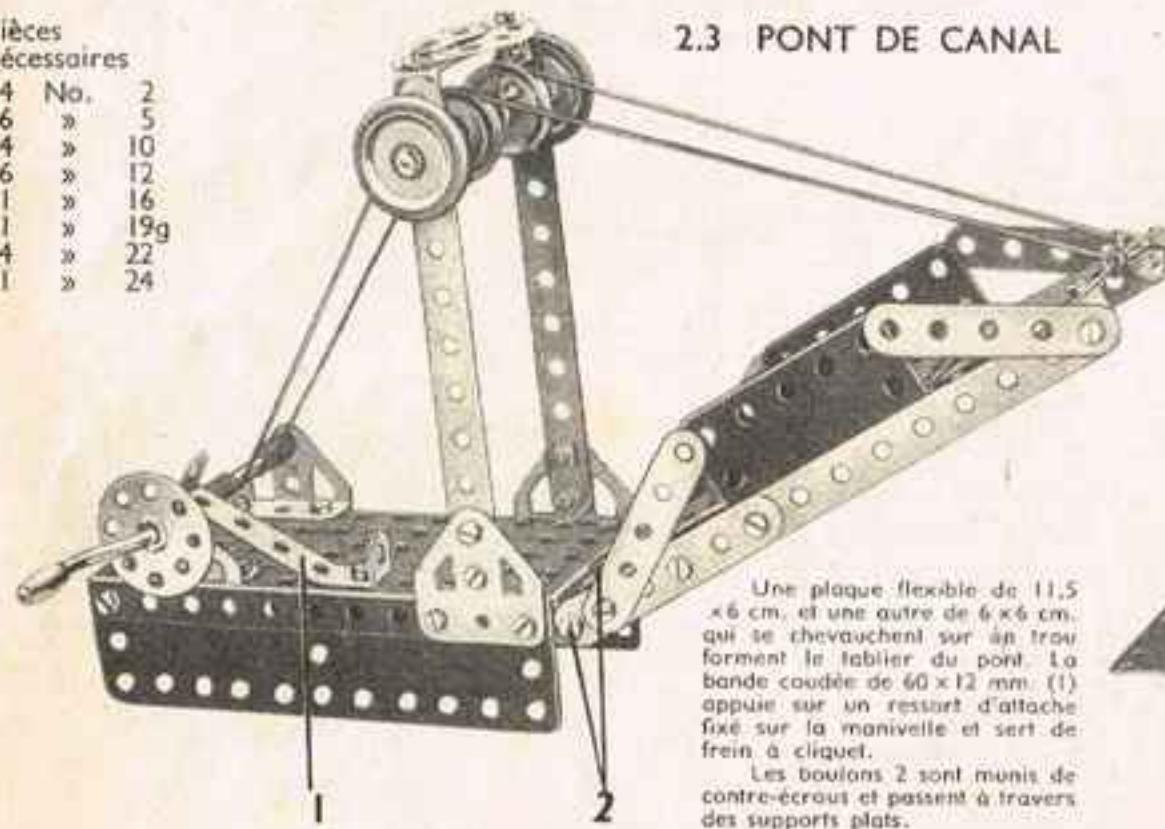
Une plaque flexible de 11,5 x 6 cm. et une autre de 6 x 6 cm. qui se chevauchent sur un trou forment le tablier du pont. La bande coulée de 60 x 12 mm. (1) appuie sur un ressort d'attache fixé sur la manivelle et sert de frein à cliquet.
