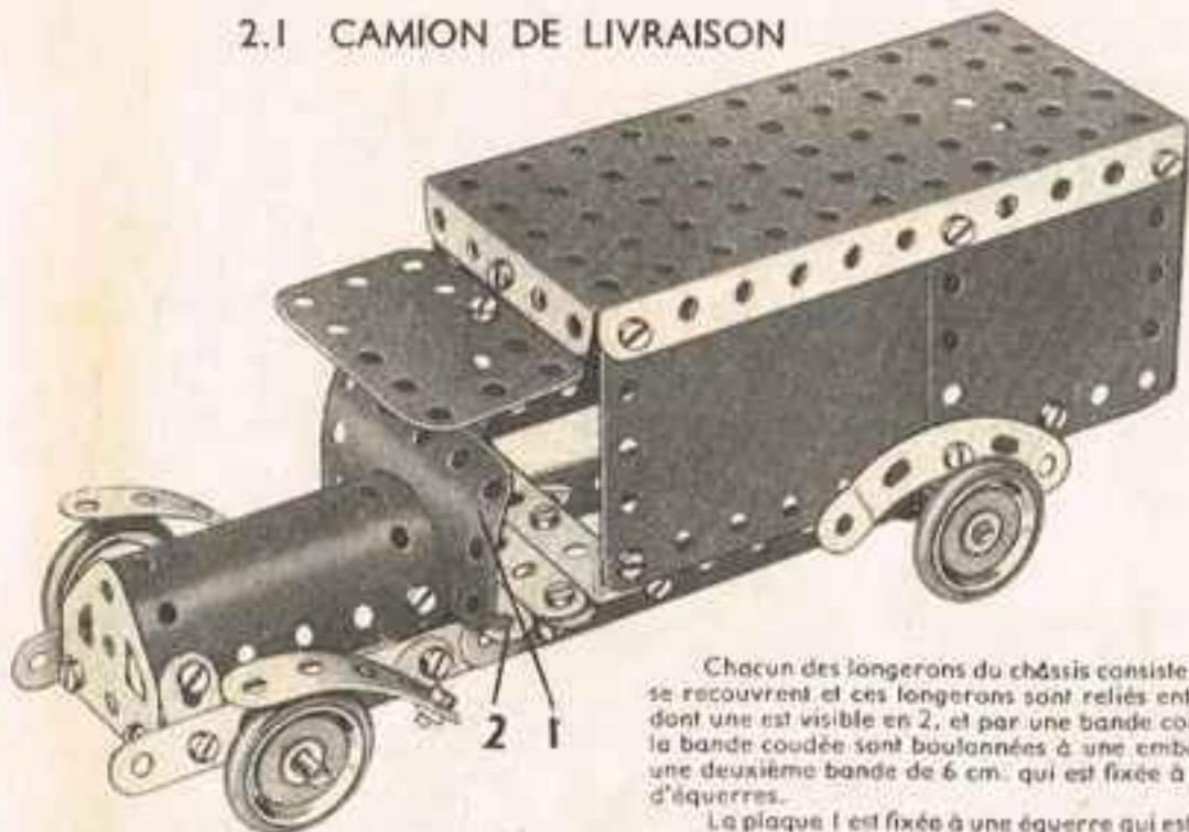
Chacun des longerons du châssis consiste en deux bandes de 14 cm., dont les extrémités se recouvrent et ces longerons sont reliés entre eux au milieu par deux bandes de 6 cm., dont une est visible en 2, et par une bande coulée de 60 x 12 mm. La bande de 6 cm. (2) et la bande coulée sont boulonnées à une embase triangulaire plate, et entre elles est placée une deuxième bande de 6 cm. qui est fixée à chacune de ses extrémités au châssis à l'aide d'équerres.
