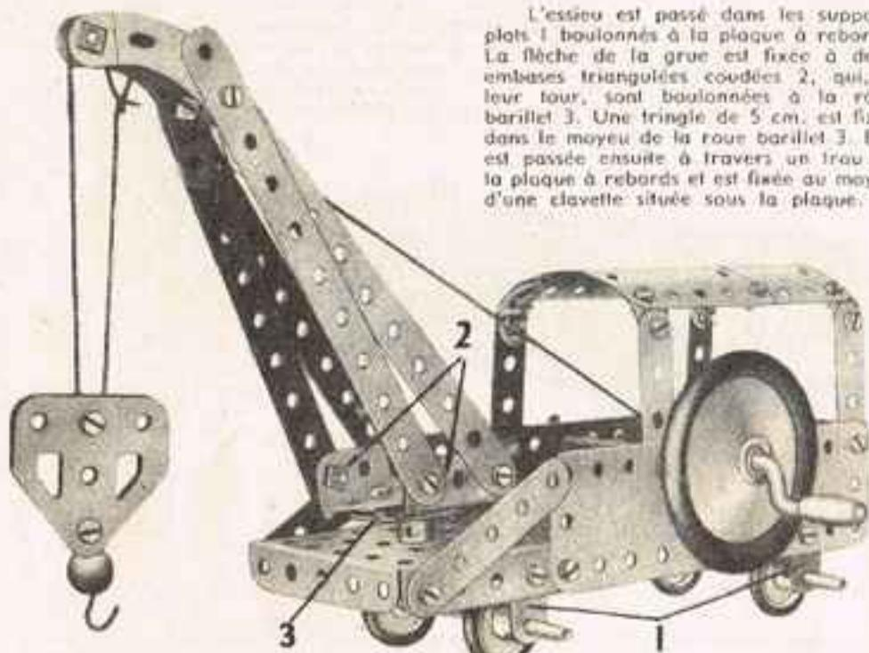
L'essieu est passé dans les supports plats 1 boulonnés à la plaque à rebords. La flèche de la grue est fixée à deux embases triangulées coudées 2, qui, à leur tour, sont boulonnées à la roue barillet 3. Une tringle de 5 cm. est fixée dans le moyeu de la roue barillet 3. Elle est passée ensuite à travers un trou de la plaque à rebords et est fixée au moyen d'une clovete située sous la plaque.
