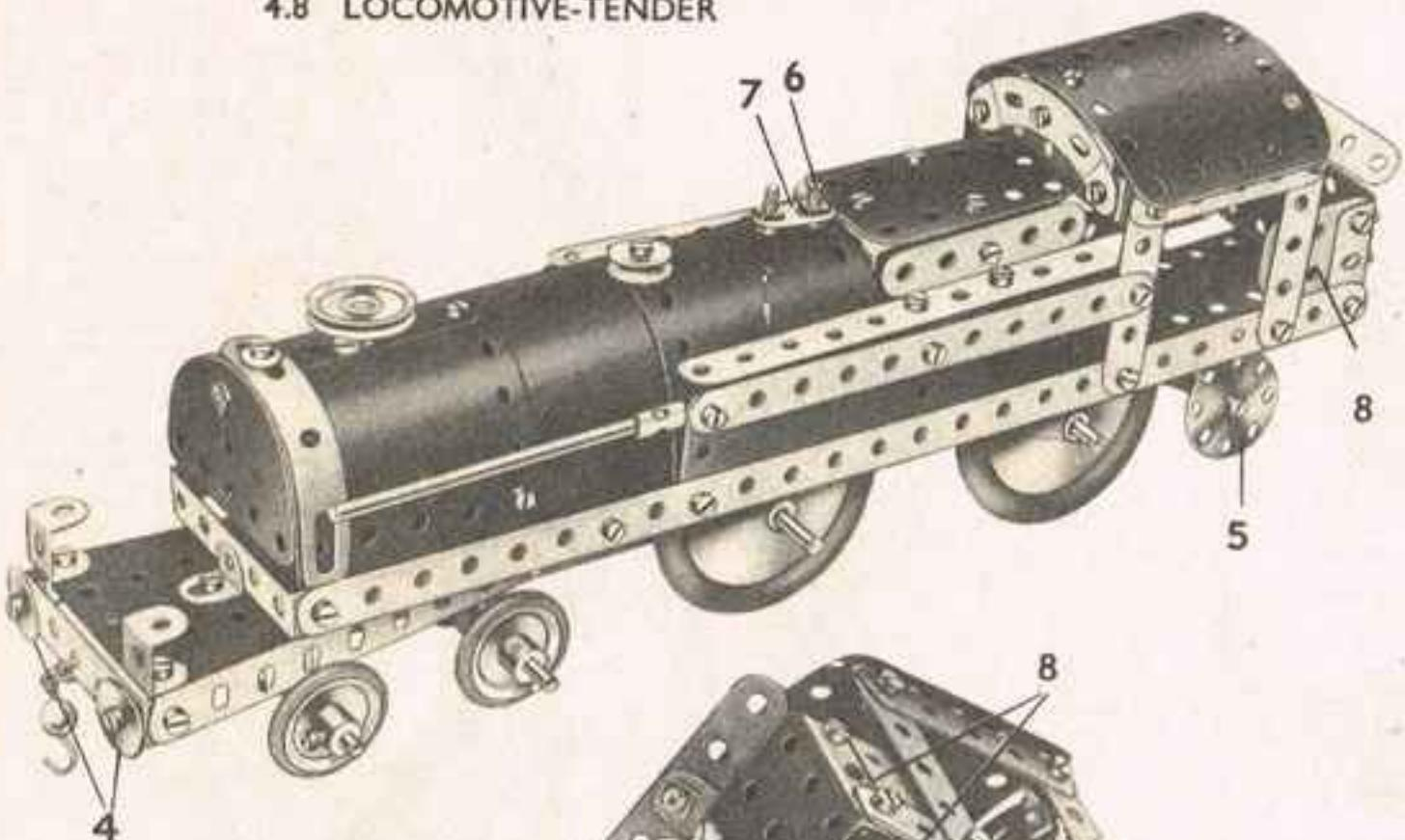
La construction de ce modèle doit être commencée par le châssis dont les détails sont représentés sur la Fig. 4.8a. Les supports plats 1 doivent être boulonnés aux bandes de 32 cm. 2 avant le montage de la plaque secteur à rebords 3. Les disques de 32 mm. 5 tournent sur des boulons à contre-écrans dans les extrémités de deux bandes incurvées de 6 cm. à petit rayon, qui sont boulonnées aux bandes de 32 cm. constituant les longerons du châssis.
