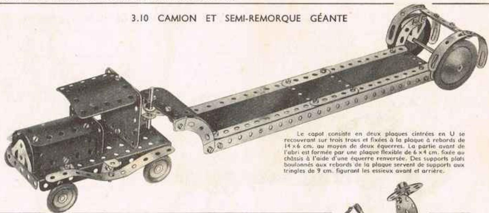
Le capot consiste en deux plaques cintrees en U se recouvrant sur trois trous et fixées à la plaque à rebords de 14x6 cm. au moyen de deux équerres. La partie avant de l'abri est formée par une plaque flexible de 6x4 cm. fixée au châssis à l'aide d'une équerre renversée. Des supports plats boulonnés aux rebords de la plaque servent de supports aux tringles de 9 cm. figurant les essieux avant et arrière.
