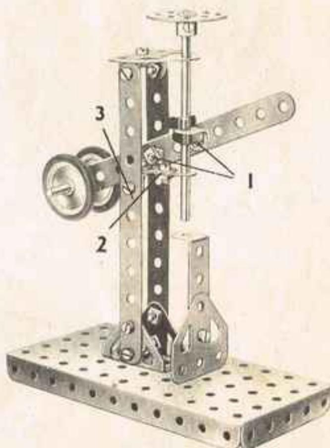
Les boulons 1 sont munis de contre-écrous. Le support inférieur du poinçon consiste en deux supports plats 2 qui sont vissés ensemble. L'un d'eux est fixé sur une équerre elle-même fixée à l'une des bandes verticales de 14 cm, par le boulon 3.
