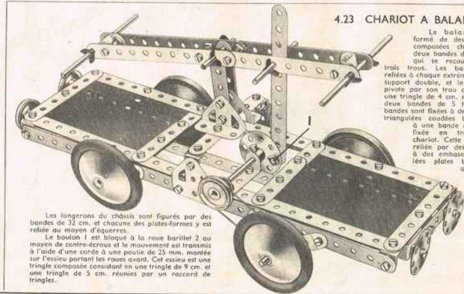
Le boulon 1 est bloqué à la roue barillet 2 au moyen de contre-écrous et le mouvement est transmis à l'aide d'une corde à une poulie de  $25$  mm. montée sur l'essieu portant les roues avant. Cet essieu est une tringle composée consistant en une tringle de  $9$  cm. et une tringle de  $5$  cm. réunies par un raccord de tringles.
