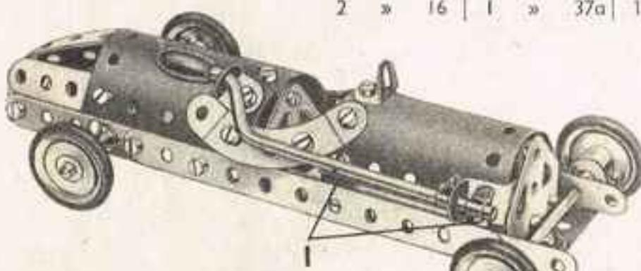
Le radiateur et le capot sont fixés au châssis au moyen des supports plats 1 de chaque côté du modèle.
