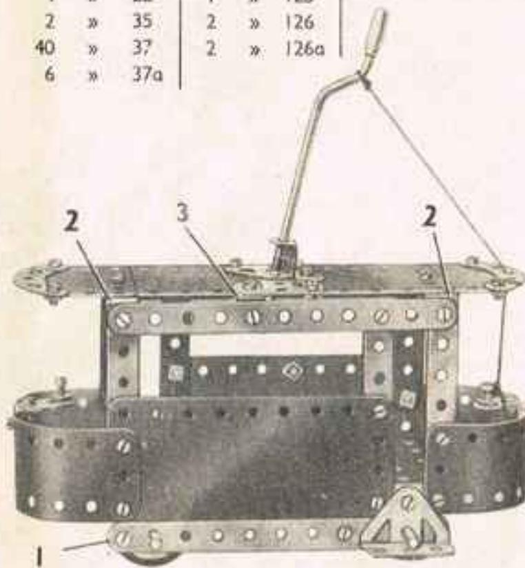
Deux plaques flexibles de 14 x 4 cm. sont incurvées et boulonnées aux extrémités d'une plaque à rebords pour former les portes de conduite et une plaque flexible de 11,5 x 6 cm. sera à former un côté du modèle. Cette plaque aussi est boulonnée à la plaque flexible. L'autre côté consiste en deux plaques cintrées, aplaniées et boulonnées l'une à l'autre. Les deux côtés sont renforcés par deux bandes perforées de 11 trous dont une apparaît en 1.
