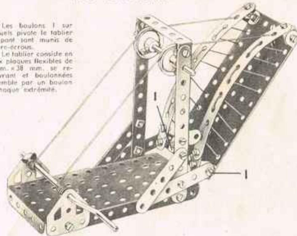
Les boulons 1 sur lesquels pivote le tablier du pont sont munis de contre-écrous.
