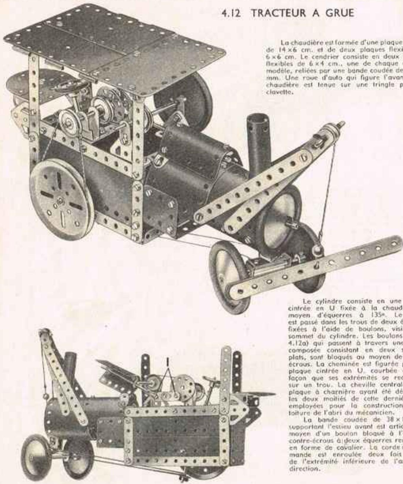
La chaudière est formée d'une plaque flexible de  $14 \times 6$  cm., et de deux plaques flexibles de  $6 \times 6$  cm. Le cendrier consiste en deux plaques flexibles de  $6 \times 4$  cm., une de chaque côté du modèle, reliées par une bande coulée de  $60 \times 12$  mm. Une roue d'auto qui figure l'avant de la chaudière est tenue sur une tringle par une clovette.
