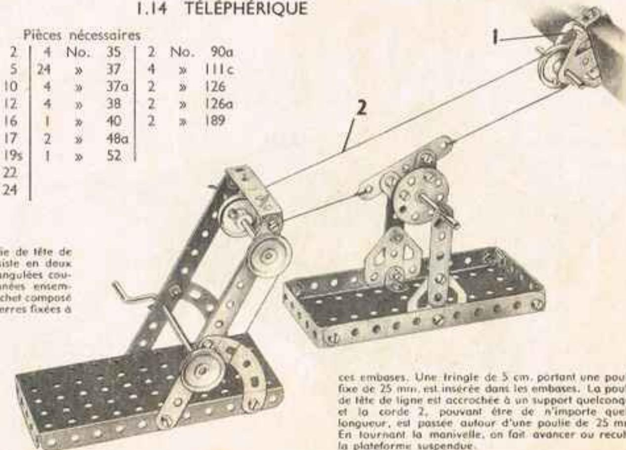
ces embases. Une tringle de 5 cm. portant une poulie fixe de 25 mm. est insérée dans les embases. La poulie de tête de ligne est accrochée à un support quelconque et la corde 2, pouvant être de n'importe quelle longueur, est passée autour d'une poulie de 25 mm. En tournant la manivelle, on fait avancer ou reculer la plateforme suspendue.
