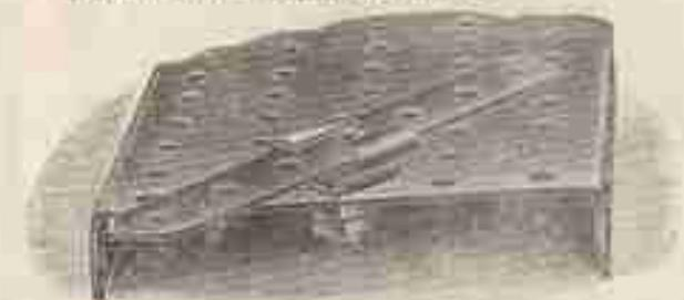
N—Plateau manivelle formé en reliant, par une articulation à contre-droite de sûreté, une roue barillet et une bande métallique.
