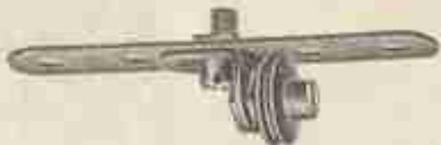
R—Support pour poulies de grandes dimensions. L'extrémité filetée du boulon pénètre dans le moyeu de la poulie et est immobilisée par rapport à cette poulie au moyen d'une vis d'arrêt.
