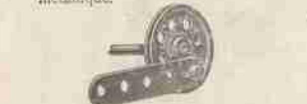
I—Transmission par engrenage pour arbres perpendiculaires.
