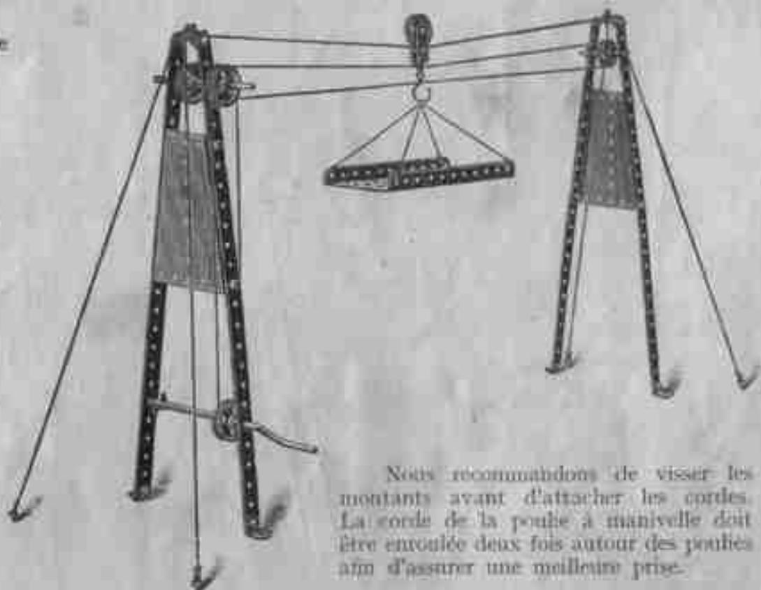
Nous recommandons de visser les montants avant d'attacher les cordes. La corde de la poule à manivelle doit être enroulée deux fois autour des poules afin d'assurer une meilleure prise.
