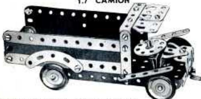
Chaque des bandes incurvées de 5 trous, représentant les garde-boue arrière, est fixée au côté du camion sur un bouton de 9,5 mm. et un aroo. Une clavette place sur le bouton sert à écarter chaque garde-boue de la paroi du camion.
