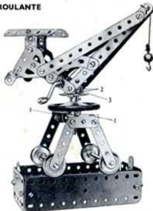
Une équerre de 5 cm, est insérée dans le trou de la mèche fixée (1). Elle est passée ensuite dans la roue d'angle et dans le trou central d'une autre coulée de 60 x 12 mm, puis solidement entre les deux embase triangulaires croisées (2). Une équerre et un essieu d'angle sont montés sur le triangle pour le bras. La partie de la grue est rattachée à la roue fixée à l'aide des écrous (3).
