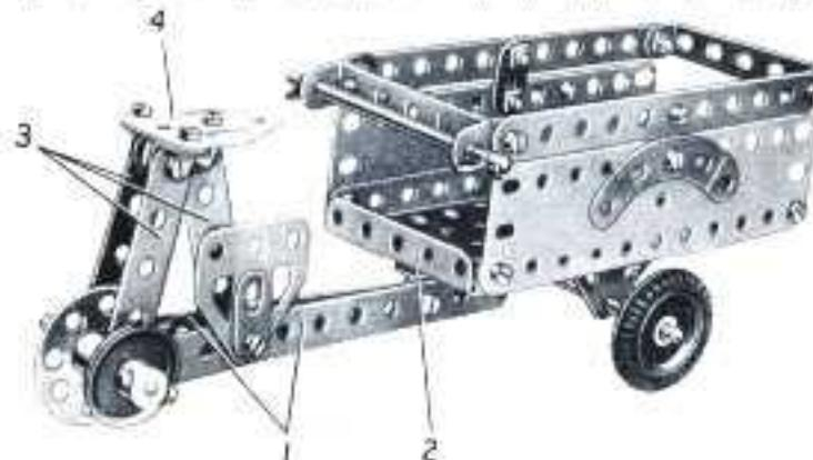
Le cadre du triporteur est construit avec deux barres (1) et trois (2) équerres à une extrémité, sur un plateau qui est fixé également aux précédentes (1). La partie de plateau sur un bouton de 25 mm. (3) est enfoncée dans le plateau et fixée par trois boulons de 5 mm. (4). L'ensemble devrait être démonté si l'on souhaite utiliser une autre partie de plateau.
