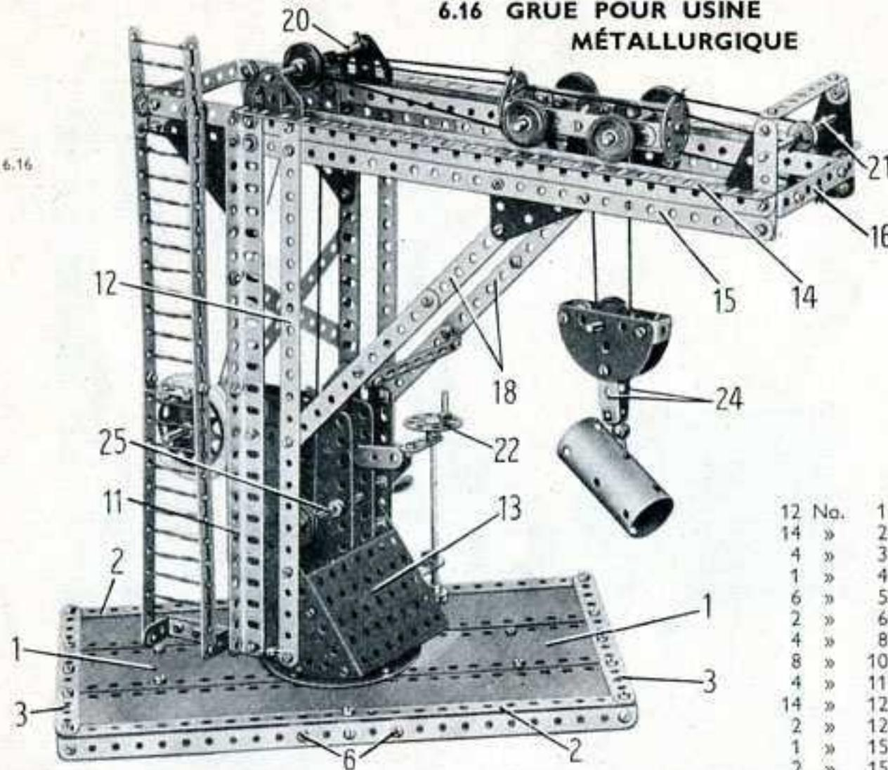
Chaque cornière (14) est prolongée à l'arrière par une bande de 11 trous qu'un support plat réunit à la bande (15). Une bande coudée de 90x12 mm. (17) est boulonnée entre les extrémités des bandes de 11 trous. La flèche est renforcée par deux bandes (18) constituées chacune par deux bandes de 11 trous qui se recouvrent sur 6 trous.
