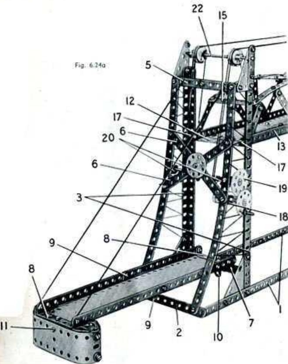
La travée mobile est guidée par quatre galets (17) qui appuient contre les faces intérieures des cornières (3). Chaque galet est constitué par une bague d'arrêt fixée sur un boulon de 9,5 mm. Ce dernier pivote librement dans un support plat boulonné aux plaques à rebords (12).
