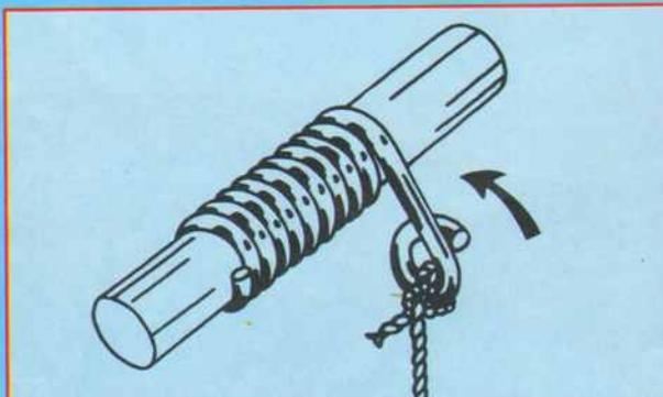
Um eine Schnur an einer Achse zu befestigen, muss die Befestigungsfeder (Nr. 176) durch Drehen in Pfeilrichtung auf die Achse geschoben werden. Die Schnur muss in die Gegenrichtung ziehen.
