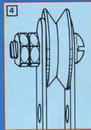
En serrant un écrou contre un autre écrou sur une même vis, on obtient le blocage de ces 2 écrous. Ce système de contre-écrou est utilisé soit pour bloquer une fixation (1) soit pour permettre à 1 ou plusieurs bandes (2 et 3) ou poulie (4) de pivoter librement.
