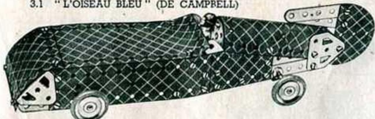
La Plaque à rebords de 14×6 cm. forme l'extrémité avant du châssis et les deux Plaques flexibles de 14×4 cm. sont boulonnées des deux côtés par le troisième trou en comprenant de l'extrémité avant du châssis. Les deux Bandes de 14 cm. formant l'extrémité arrière du châssis recouvrent les Plaques flexibles de 14×4 cm. sur un trou.
