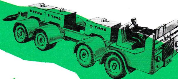
**936 L - Le châssis d'essai 8 roues Leyland.**
