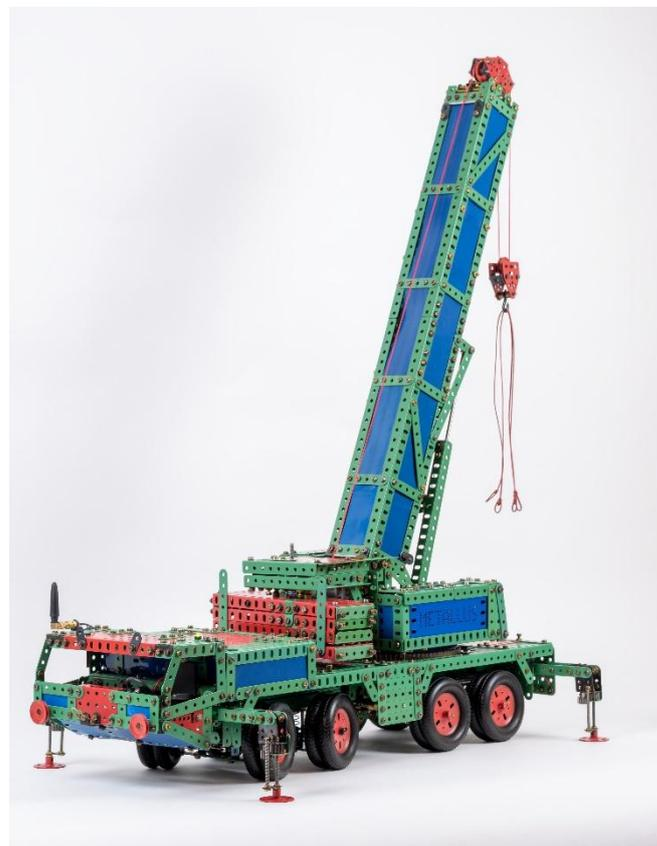
*Bild 8: Kran in Ballastaufnahmeposition (Ballastgewichte in vollständig angehobener Position)*
