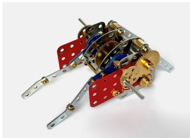
*Bild 04: Das Getriebe von links gesehen. Links im Bild die Hebel zur Steuerung der Kniegelenke. Rechts oben die Hebel zur Steuerung der Arme.*
