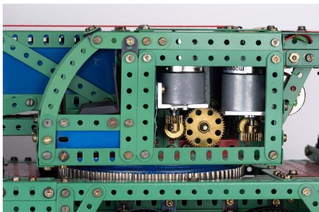
Bild 12: Antriebe der Seiltrommeln für Ausleger (links) und Teleskop (rechts)
