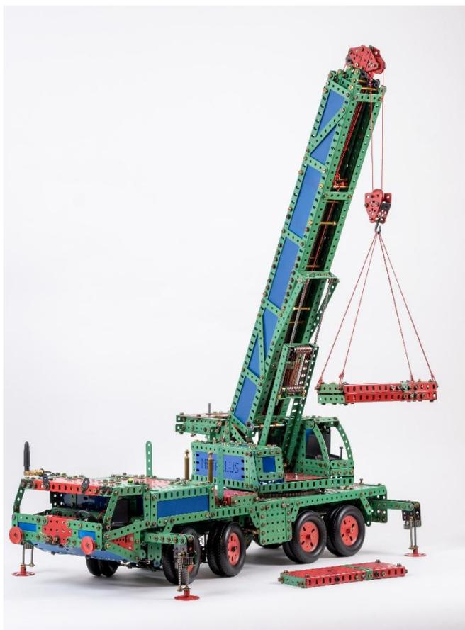
*Bild 6: Aufnahme des mittleren Ballastgewichtes (das untere liegt bereits in der Mitte des Oberwagens)*
