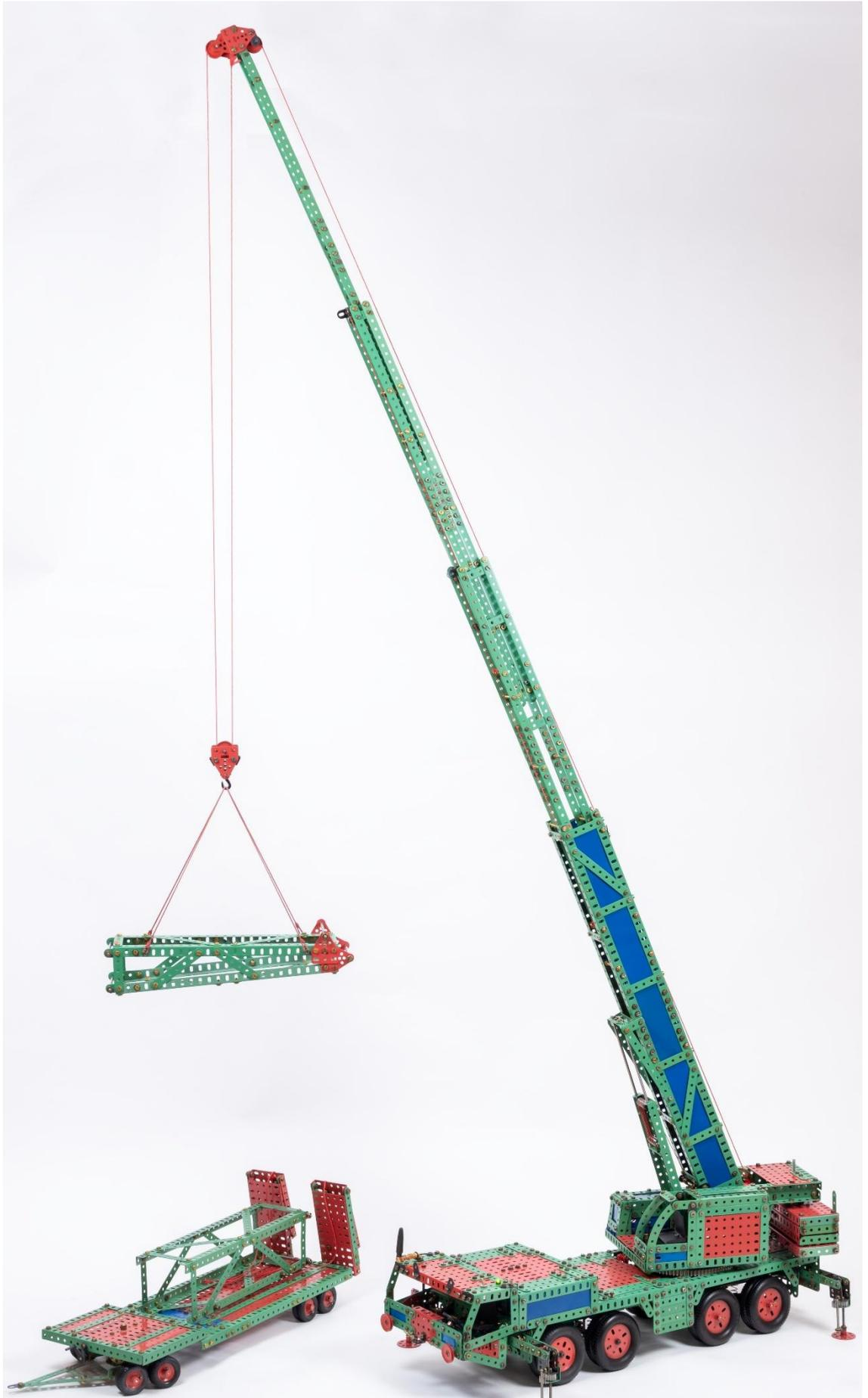
Um ruckfreie Bewegungen und hohe Betriebssicherheit zu erreichen, werden für die Seilumlenkungen kugelgelagerte V-Nut-Umlenkrollen mit einem Außendurchmesser von 12 mm verwendet. Für den Kranbetrieb haben sich nach einigen Tests Seile als vorteilhaft erwiesen, die einerseits eine hohe Längssteifigkeit aufweisen und andererseits ohne Schäden dauerhaft über die kleinen Umlenkrollen laufen können.
