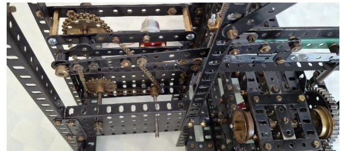
Abb. 10: Säge mit Antrieb über Kette und Kurbel
