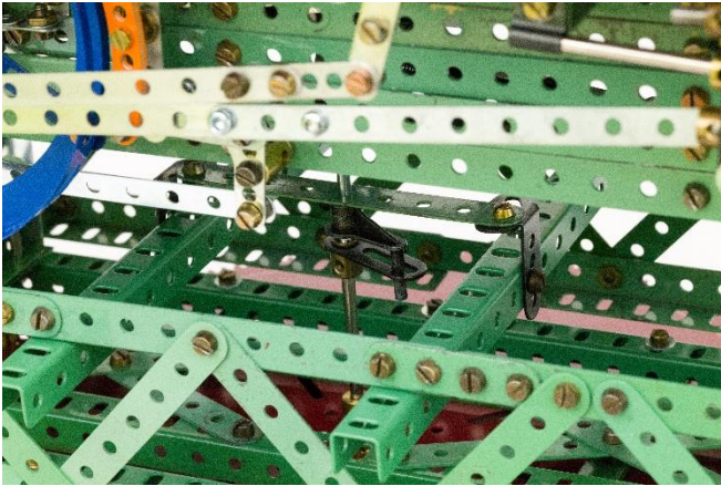
Abb. 23: Übertragung der Drehbewegung über Hebelarm mit Langloch und Handkurbel zum Ausgleich von Toleranzen
