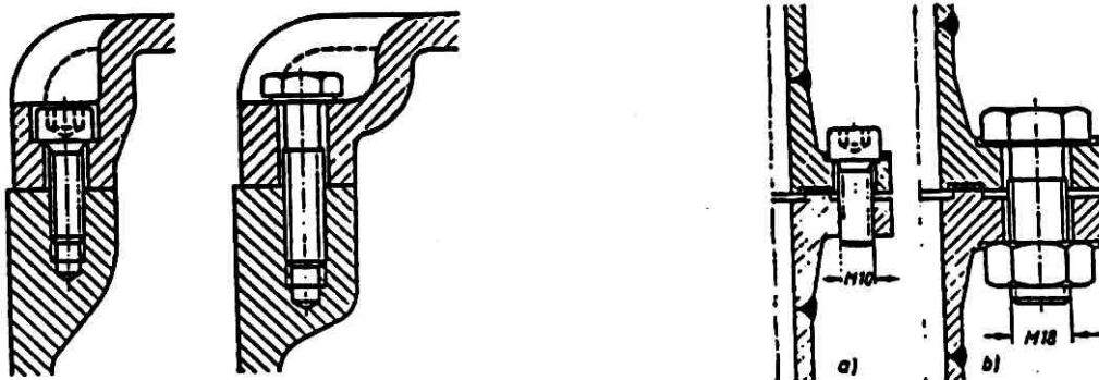
Fig. 5.6 Economie de place autour des vis à 6-pans creux.
