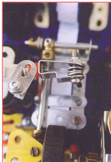
▲▼ 1 & 2 - Zone 6 : Guide de bande papier, zone 5 - Mécanisme d'avancement du papier.
