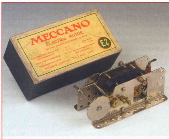
▲ N°2 - Moteur à renversement de marche (E2)
