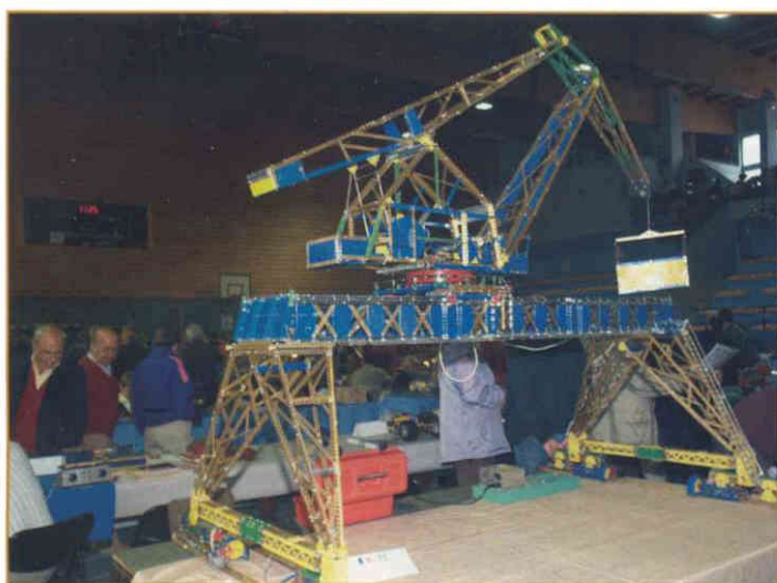
Pont roulant avec une grue à flèche compensatrice pour décharger ou charger les containers dans les ports : Le pont est d'une longueur de 2,40 m, largeur 1,50 m, hauteur 2,5 m. Au sol, déplacement sur deux rails parallèles, 4 moteurs. Déplacement de la grue sur le pont, 2 moteurs. Rotation de la flèche sur un roulement à 16 galets 1 moteur. Compensation de la flèche 1 moteur. Treuil de levage 1 moteur. Total 9 moteurs pour un poids de 30 kg environ
