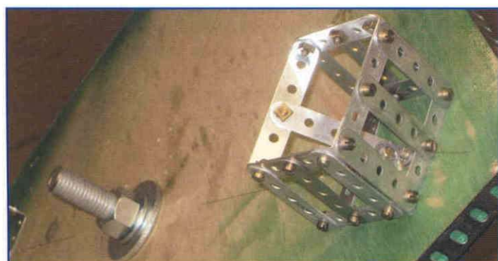
▲ Vue du dessous avec 4 pieds biseautés (pour supporter l'ensemble, la vis va jusqu'au sol).
