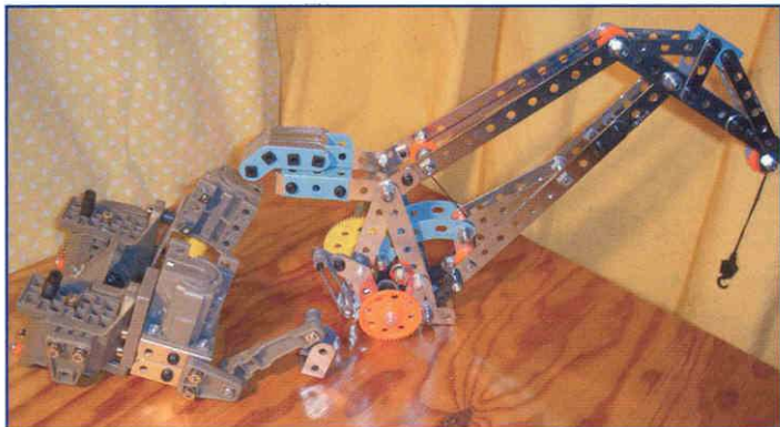
▲ Figure 5 - Moteur électrique du treuil de levage et son réducteur (12 dents/50 dents)
