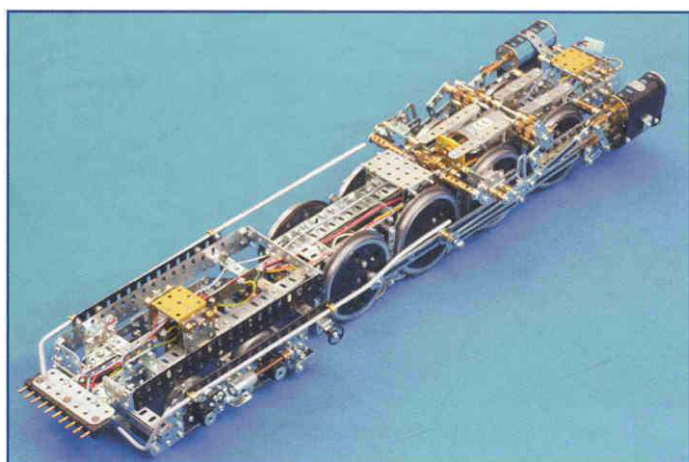
▲ Châssis fixe. Au premier plan les broches des liaisons électriques entre tender et loco.
