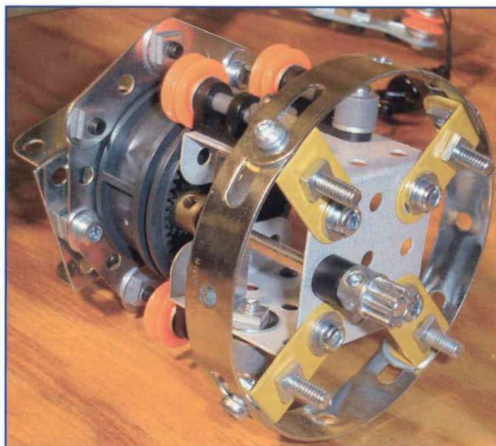
▲ Figure 2c - Couronne d'orientation
