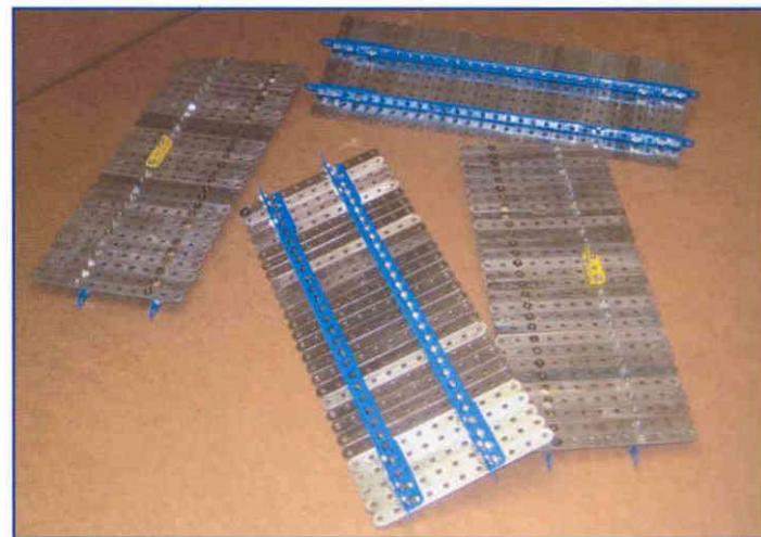
▲ Quatre panneaux de chacun 29 barres de 11 trous avec, en terminaison, des orifices permettant l'assemblage.
