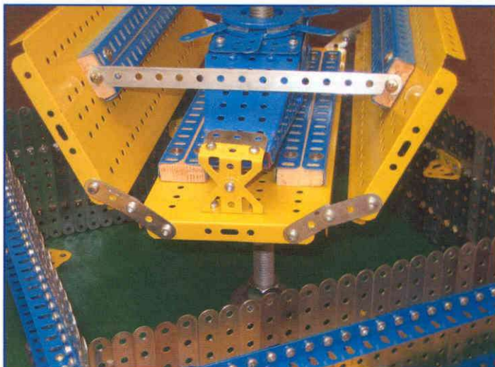
▲ Sur la planche du milieu du tablier, 2 crampons sont là pour permettre au bloc de pressurage de s'encastrer et de relever toute la table pour le chargement.
