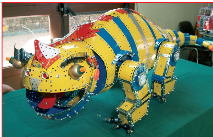
"Le Meccaleon" : C'est un caméléon qui comporte 4 moteurs pour le faire marcher, tourner la tête, ouvrir la bouche et tourner les yeux. Longueur du modèle : 1,45 m. Poids : 16 kg.
