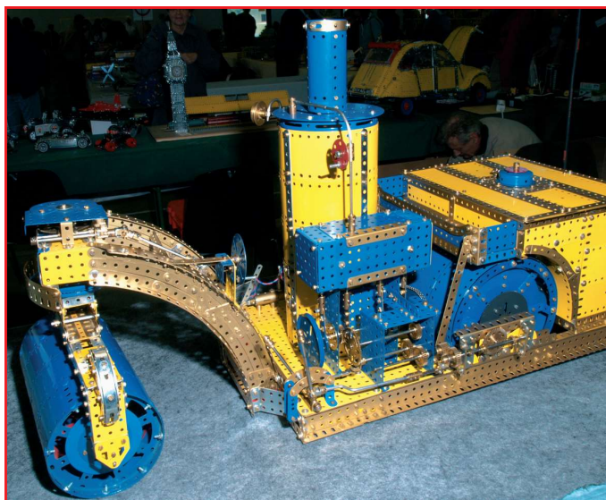
Rouleau à vapeur à machine verticale : construit vers 1865 par Thomas Aveling en Angleterre, échelle 1/15, longueur 0,9m, largeur 0,32m, 2 vitesses et inversion de marche, poids 20kg.
