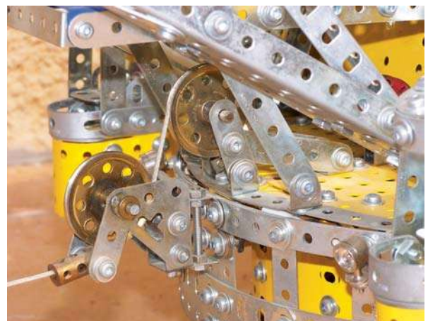
Photo 10 : détail du guidage du câble de traction du godet
