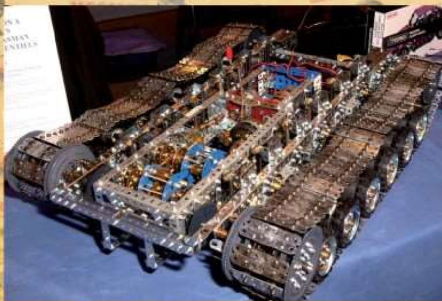
Châssis à chenilles à transmission Gleasman de Michel Perrin
