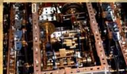
Châssis à chenilles à transmission Gleasman de Michel Perrin
