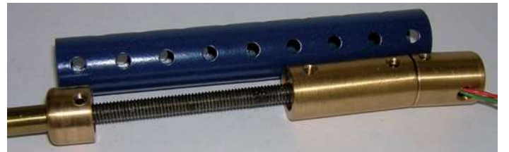
Vérin Somerville – Dennis. Trouvables chez un revendeur anglais, utilisant le manchon n° 163 en différentes longueurs et un mini-moteur à réducteur trouvable dans certains magasins de modélisme.
