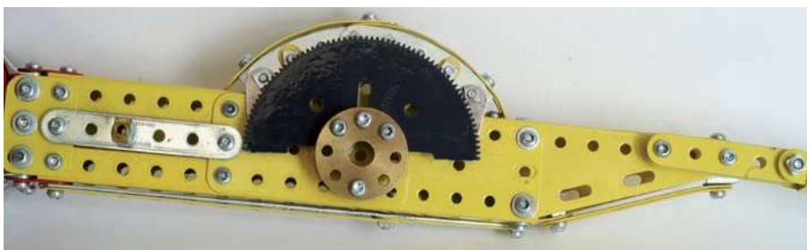
Photo 5 : La roue de 133 dents, coupée en deux et servant à l'entraînement des bras actionnant la flèche.
