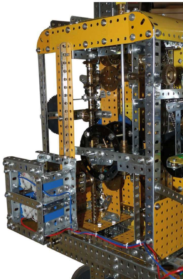
La face avant du projecteur et le mécanisme avec son moteur d'entraînement
