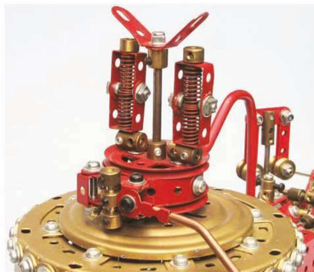
Fig. 6 Soupapes de sécurité, levier de commande et conduite de vapeur à l'arrière
