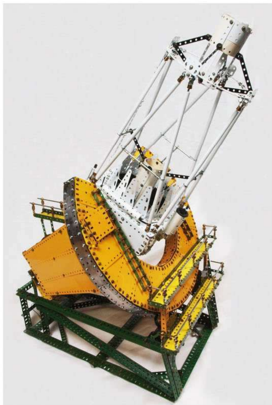
Fig. 2: Le modèle de télescope. La grosse monture en fer à cheval tourne autour de l'axe polaire qui est incliné vers le pôle sud céleste avec l'angle approprié de 31°.
