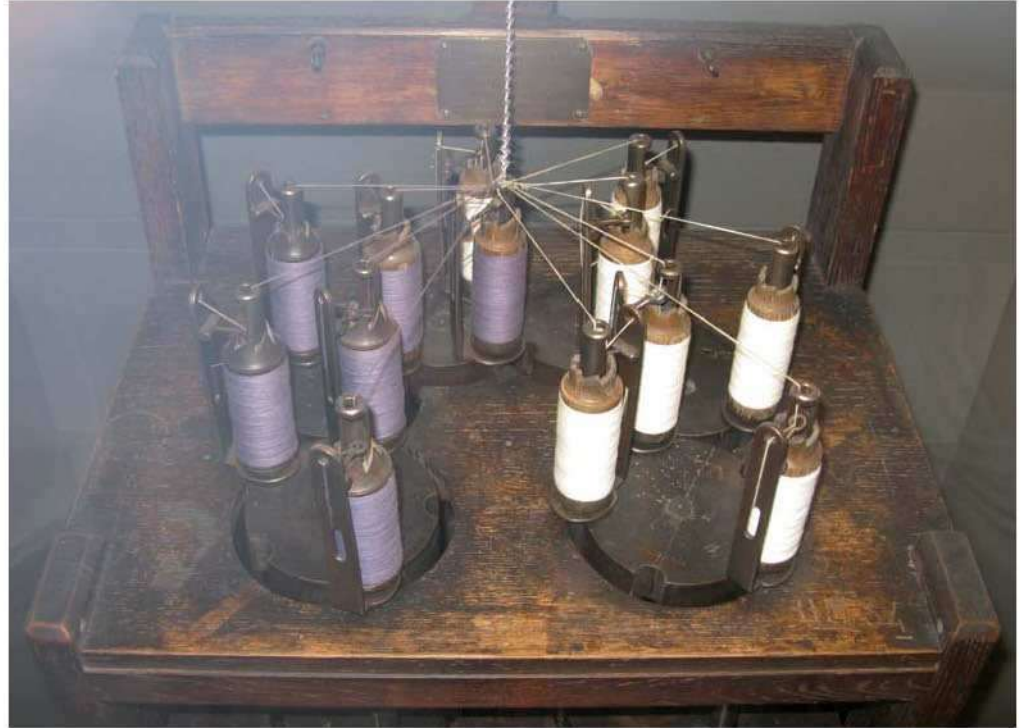
Figure 1 Machine à faire des tresses plates au Musée des Arts et Métiers, Paris
