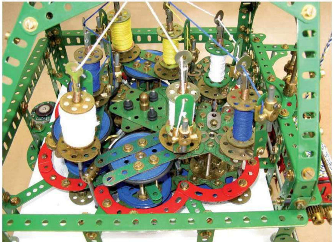
Figure 8 Montage des bobines sur les têtes porteuses
