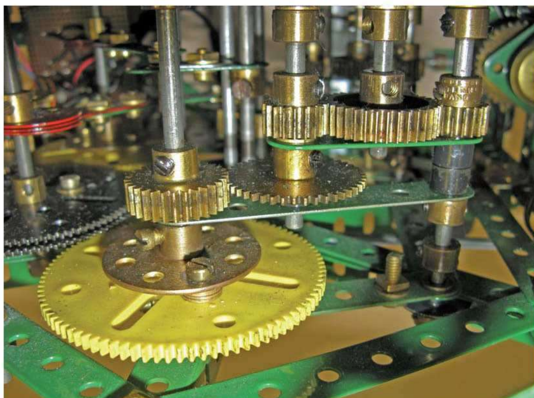
Figure 5 Réduction pour les têtes porteuses d'extrémités
