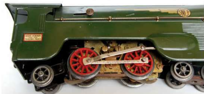
Les deux moteurs : avant-guerre, flasques de la platine en laiton – après-guerre flasques en acier. C'est bien la meilleure solution pour dater une locomotive...
