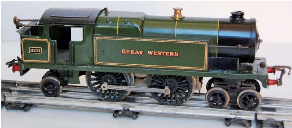
Loco mécanique 1934. Notez, comme sur la plupart des machines des G.W.R., la soupape de sécurité couleur cuivre qui remplace le dôme traditionnel.
