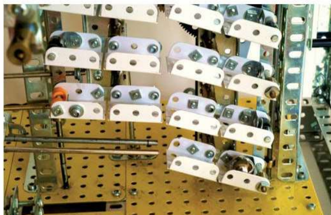
Photos 9 et 10 - Ces photos illustrent le principe de levage des billes en les transférant de gauche à droite et vice-versa, ce qui les fait monter d'un niveau à chaque fois jusqu'à ce qu'elles atteignent un tube, situé au niveau supérieur, qui les conduit vers les rails.
