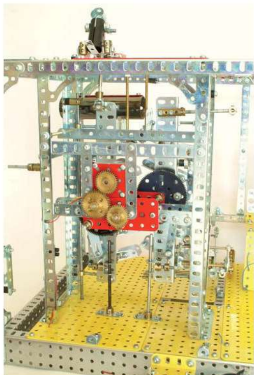
Photo 8 - Vue de derrière. Le moteur est fixé sur les plaques rouges et entraîne 2 roues de 95 dents, faisant fonction d'excentrique pour actionner les bras verticaux porteurs des godets. La grande roue bleue, servant d'ascenseur auxiliaire et ôtée pour les besoins de la photo, est entraînée par les engrenages situés au devant des plaques rouges.
