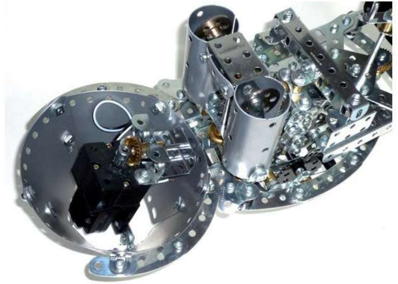
La cuve ouverte fait apparaître le moteur et son réducteur
