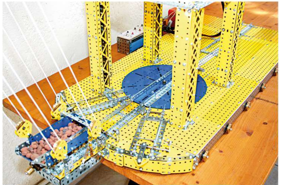
Fig. 5 Position de départ, wagon chargé et verrouillé sur la voie de lancement centrale
