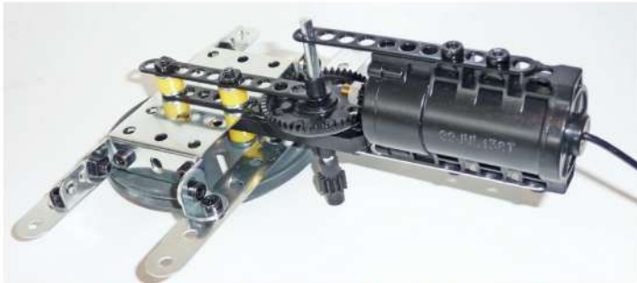
Fig. 26 Partie supérieure du roulement et son moteur
