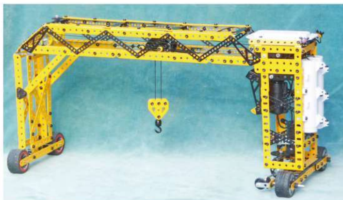
Fig. 33 Portique de manutention
