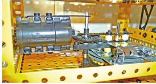
Fig. 27 Partie supérieure du roulement en place dans la cabine
