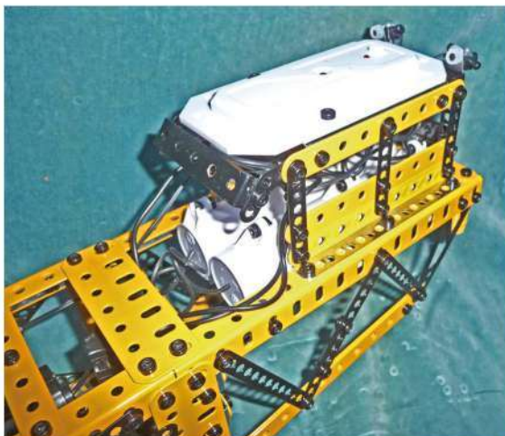
Fig. 17 La cabine avec le boîtier de commande et les boîtiers des piles
