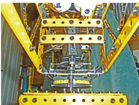
Fig. 10 Le moteur commandant la rotation
