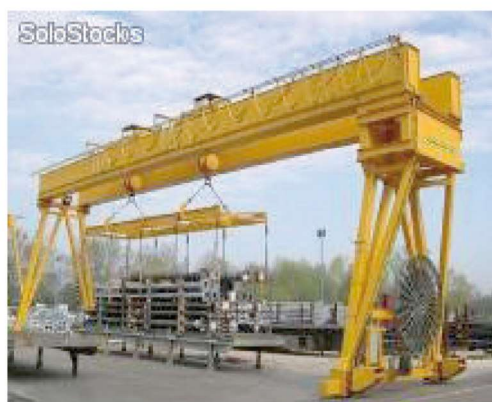
Fig. 14 – Portique de manutention
