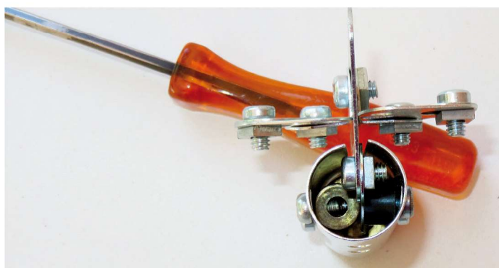
Fig. 8 Gros plan sur la fixation de l'empennage
