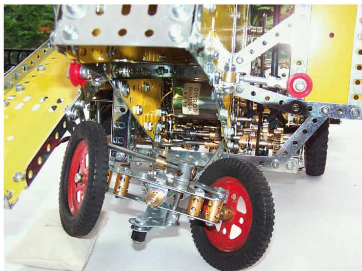
Fig. 9 L'essieu arrière monté sur pivot et excellent rayon de braquage
