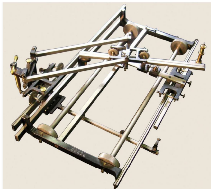
Fig. 3 Cet intégraphe de Coradi, visible au musée des Arts et Métiers, a servi de modèle pour le modèle réalisé en Meccano
