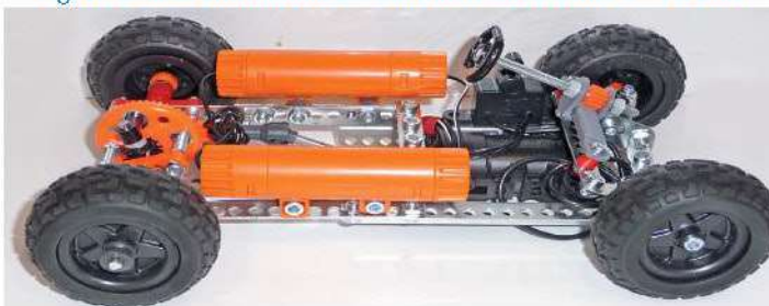
Fig. 19 Châssis automobile avec le micro-différentiel 2 ème version
