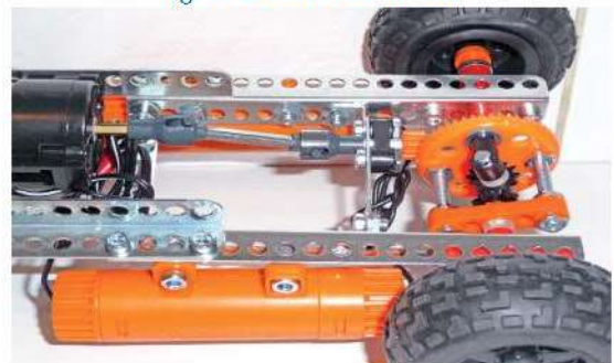
Fig. 20 La liaison au moteur avec une roue de chant
