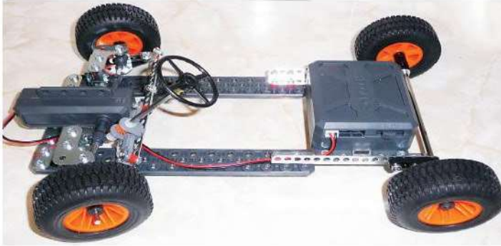
Fig. 11 Châssis automobile à traction avant
