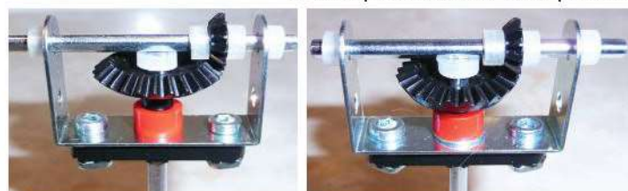
Fig. 9 Compatibilité avec les pignons d'angle 26 et 24 dents
