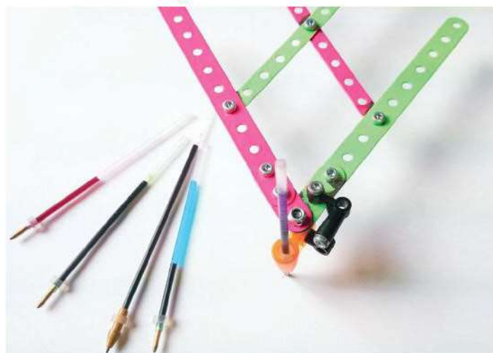
Fig. 6 Dispositif de préhension du crayon
