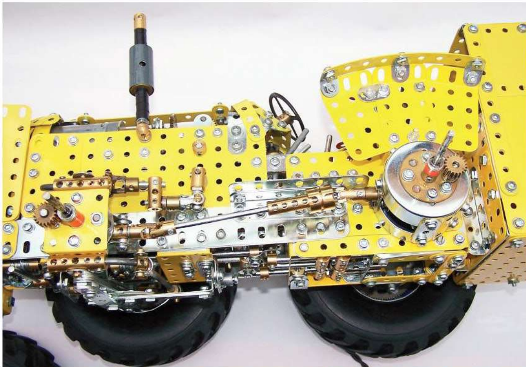
Fig. 5 La vue du côté gauche avec les roues déposées nous montre la transmission finale au niveau des roues ainsi que l'entraînement de la roue avant
