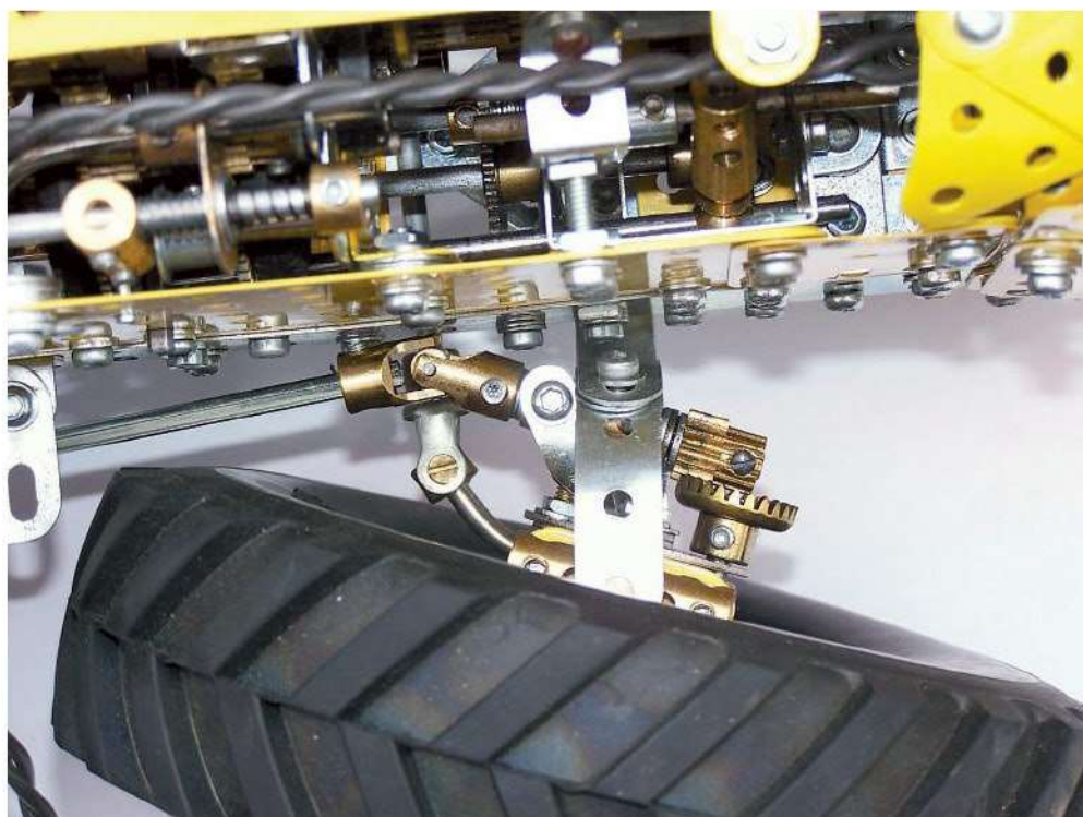
Fig. 8 La transmission de la roue AV droite avec la roue braquée au maximum. L'emploi de cardan type Marklin permet d'avoir un angle de braquage supérieur.
