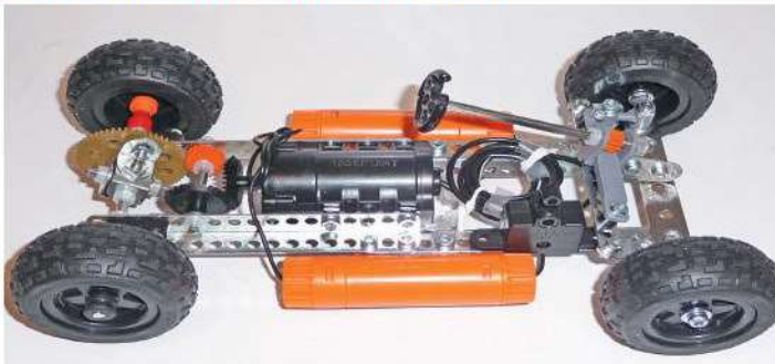
Fig. 17 Châssis automobile avec le micro-différentiel 1 ère version
