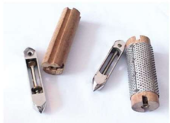
Fig. 6 Navettes types 1 et 2 N° 104, rouleaux de métier à tisser N° 106 et 106a de Jean-Pierre Greiner
