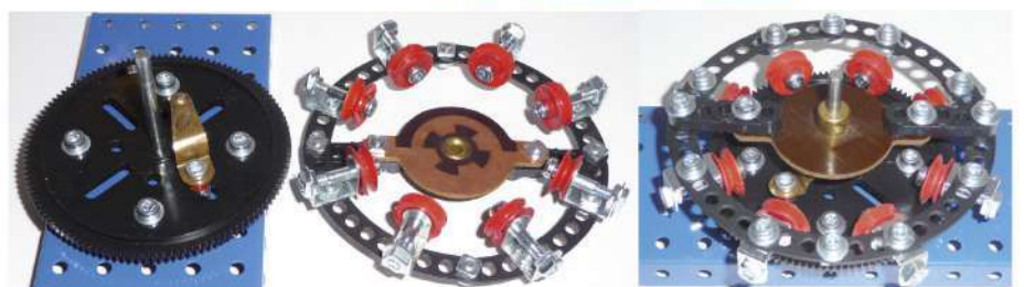
Fig. 6 – Contact tournant entre la partie fixe et la partie mobile
