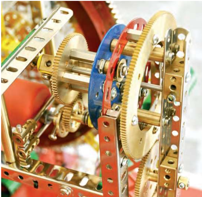
Fig. 6 Detail de l'entraînement de l'ascenseur avec mécanisme Cardan pour billes bleues
