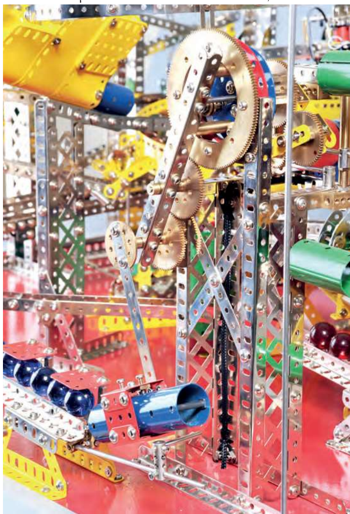
Fig. 5 Ascenseur avec mécanisme Cardan pour billes bleues
