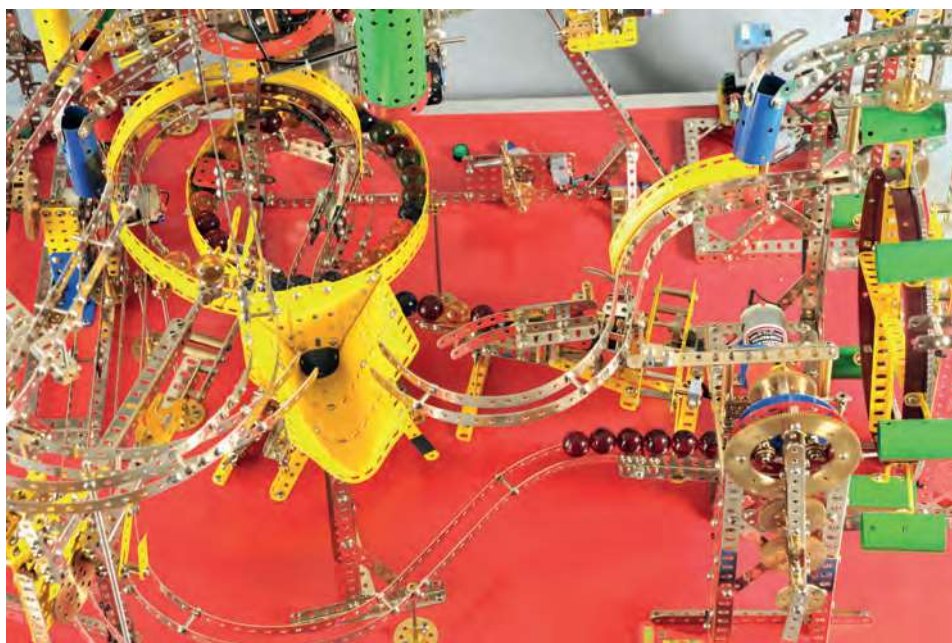
Fig. 10 Rampe circulaire et chargeur de billes
