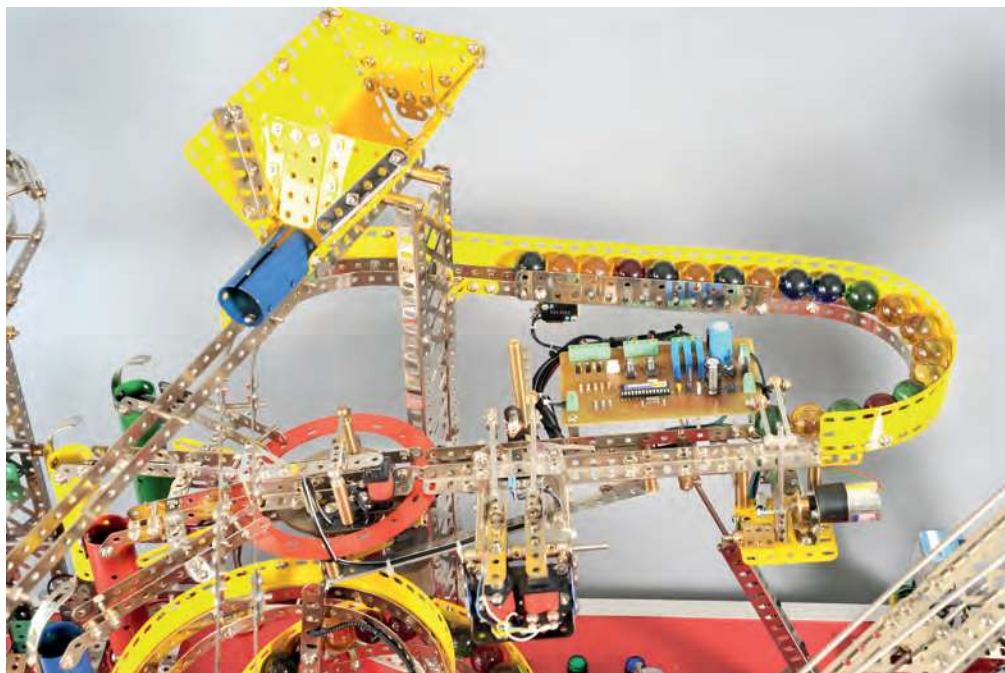
Fig. 2 Trieur de couleur et sa rampe d'alimentation
