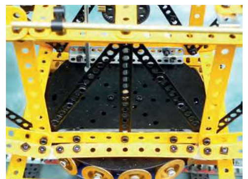
Fig. 10 Fixation des côtés sur la plaque circulaire
