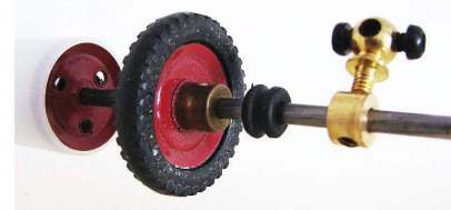
Fig. 4 Serrage du tambour
