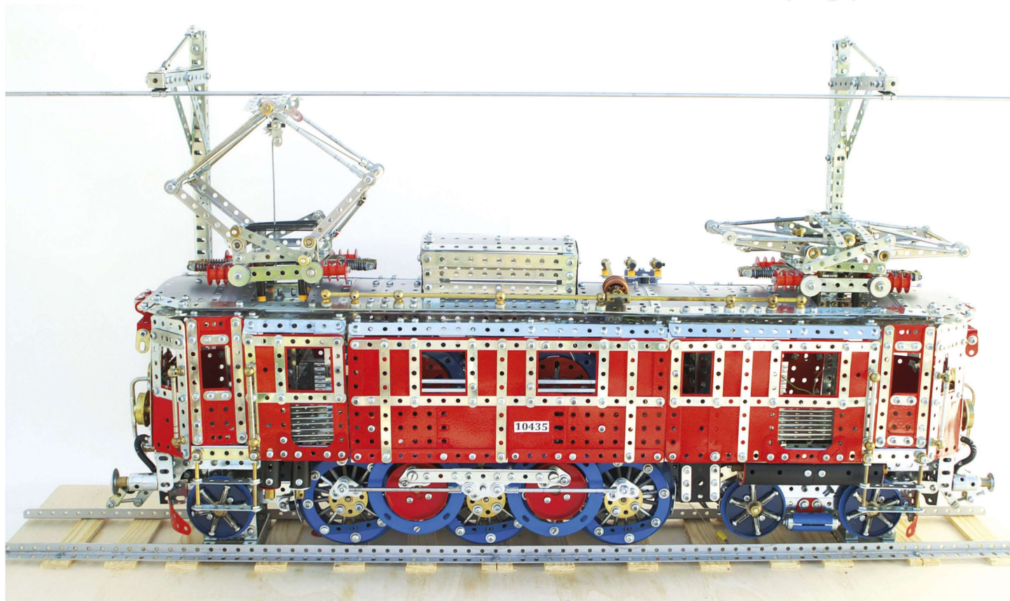
Fig. 1 La locomotive vue côté spectateur, paroi latérale fermée, pantographe arrière levé. Les locos suisses n'avaient toujours qu'un pantographe, l'arrière, en position haute
