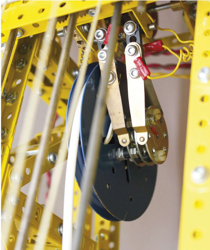
Fig. 16 Gros plan sur l'enrouleur de câble et ses contacts pour la liaison électrique
