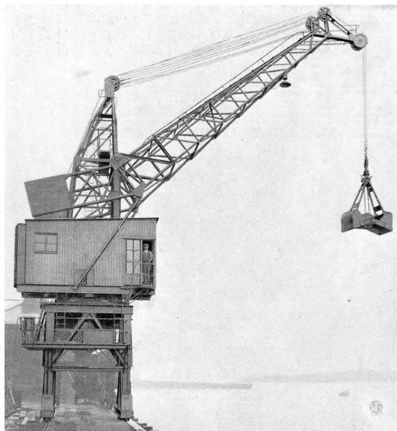
Fig. 1 Grue Stother & Pitt système Topliss
