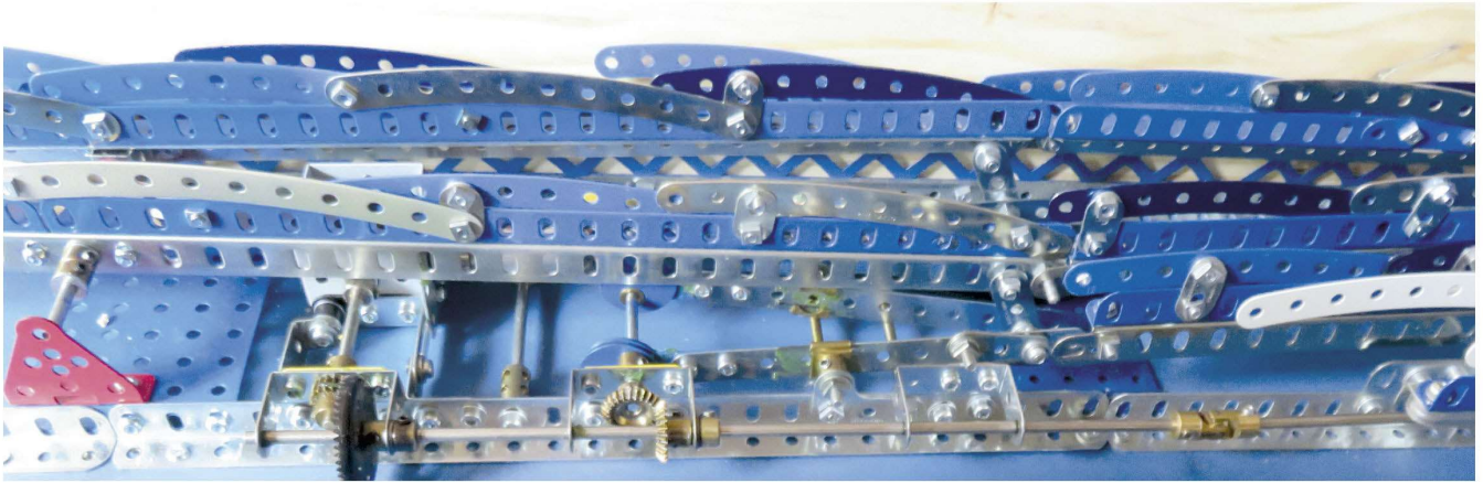
Fig. 6 Le mécanisme des vagues de devant constitué de chaque coté par un excentrique relié à un bout de l'élément central (celui de la dernière vague est enlevé)
