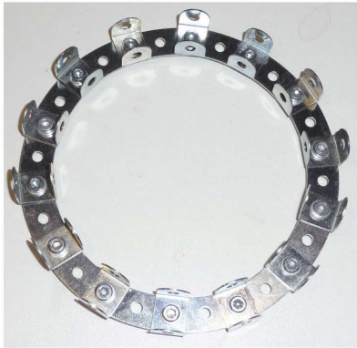
Fig. 11 L'anneau porteur de galets
