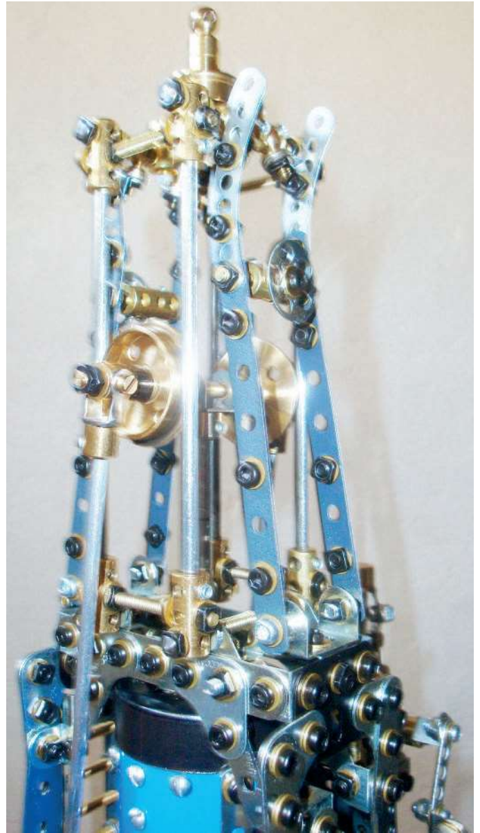
Fig. 7 Glissières et galets de guidage
