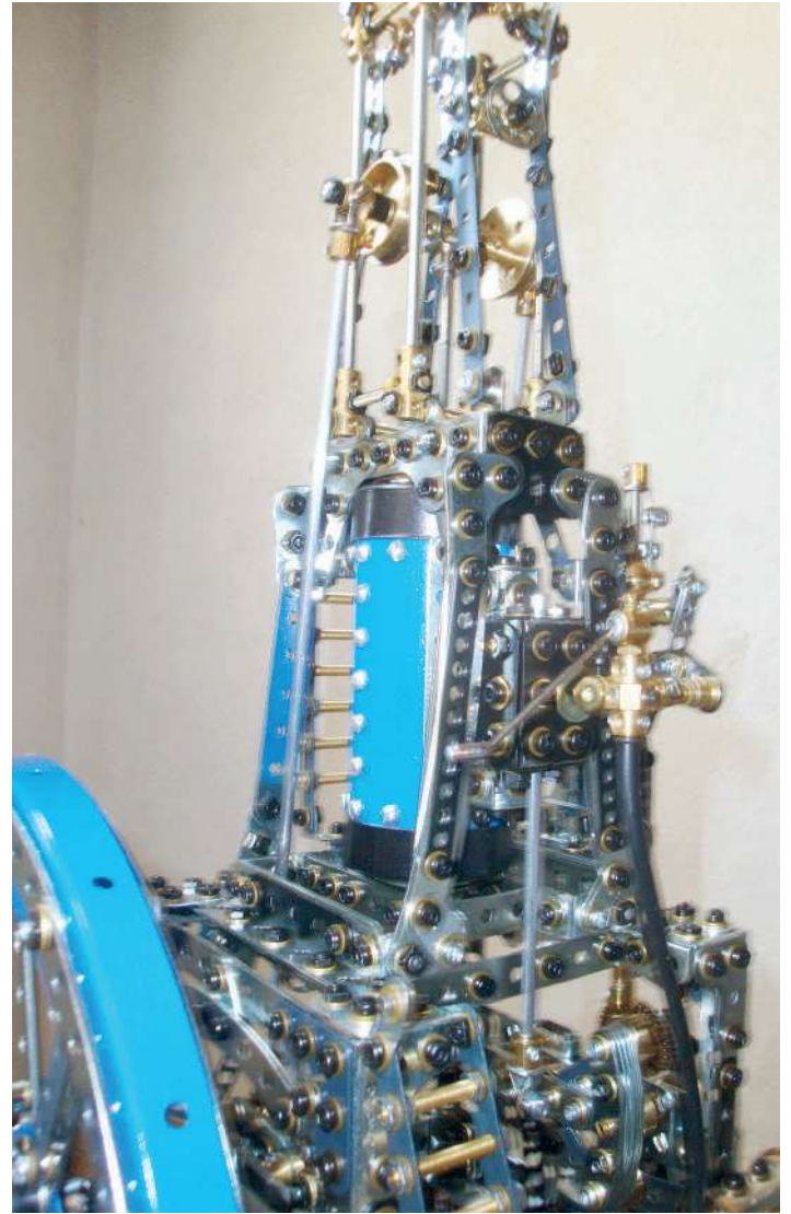
Fig. 13 Autre vue coté transmission régulateur centrifuge
