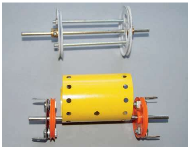
Fig. 5 Constitution des tambours des treuils des chariots blanc et rouge
