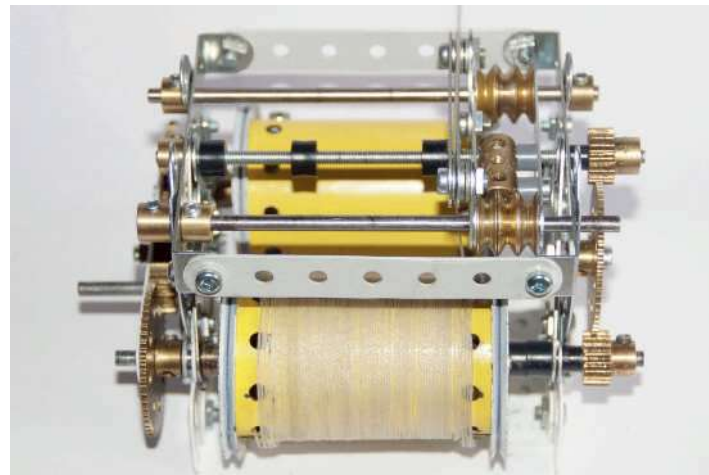
Fig. 6 Guidage par tige filetée du câble et des poulies du moufle des chariots blanc et rouge
