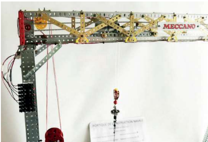
Fig. 8 Liaison électrique pylône-poutre
