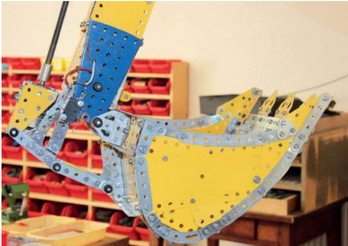
Fig. 9 Contact de fin de course au niveau du godet
