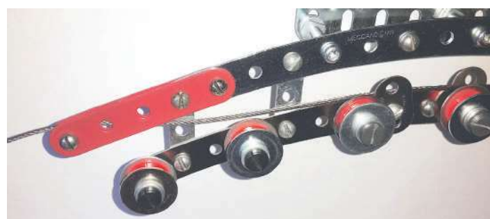
Fig. 13 Support du câble porteur et galets pour le câble tracteur
