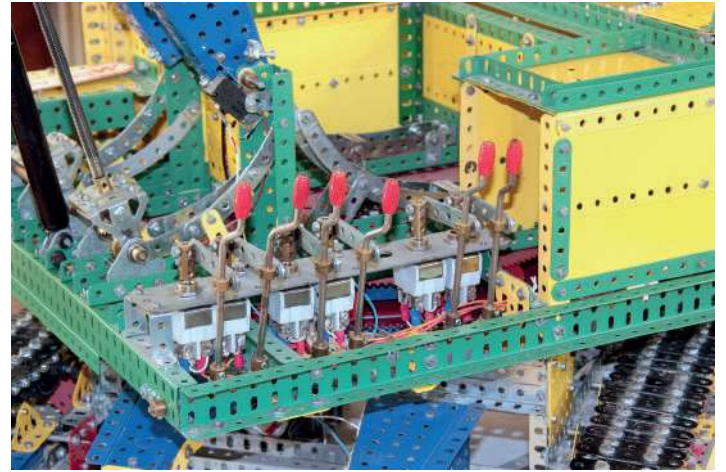
Fig. 11 Un poste de conduite bien garni, avec de gauche à droite : les trois premiers leviers pour les mouvements des bras, le quatrième pour la rotation de la tourelle, le cinquième pour l'orientation du châssis, le dernier pour la marche AV et AR
