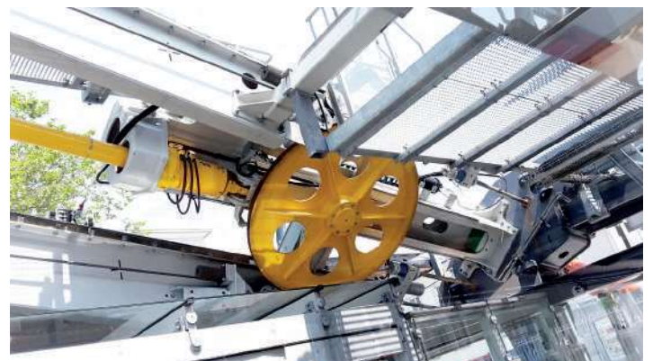
Fig. 6 Une des poulies de renvoi et le vérin pour son déplacement
