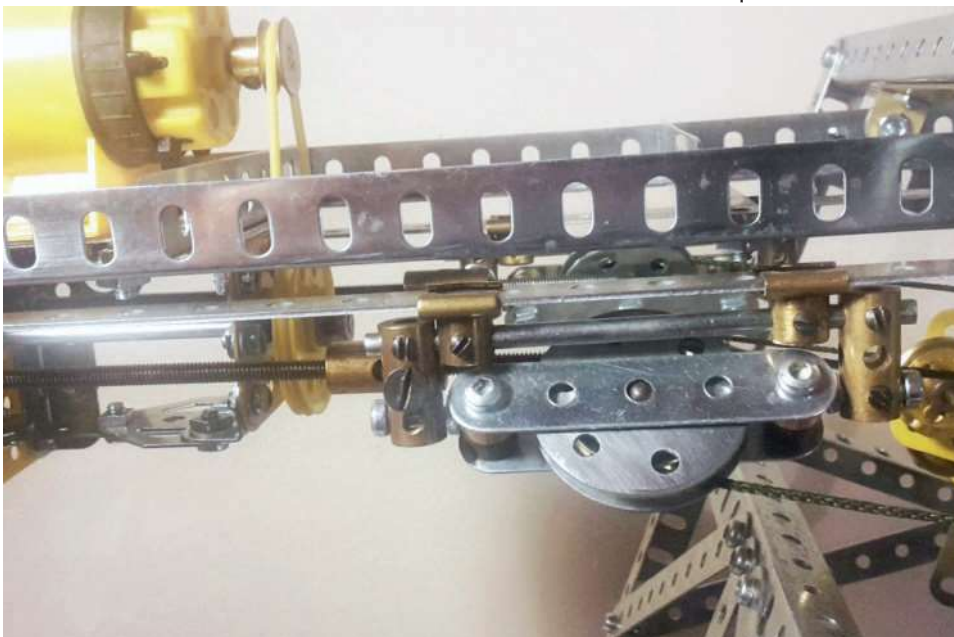
Fig. 16 Poulie de renvoi et son système de déplacement longitudinal
