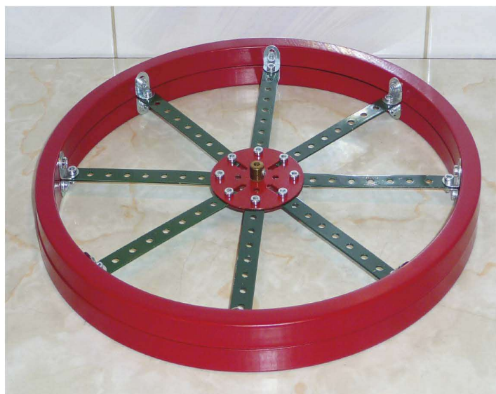
Fig. 2 Un volant fait de deux couronnes
