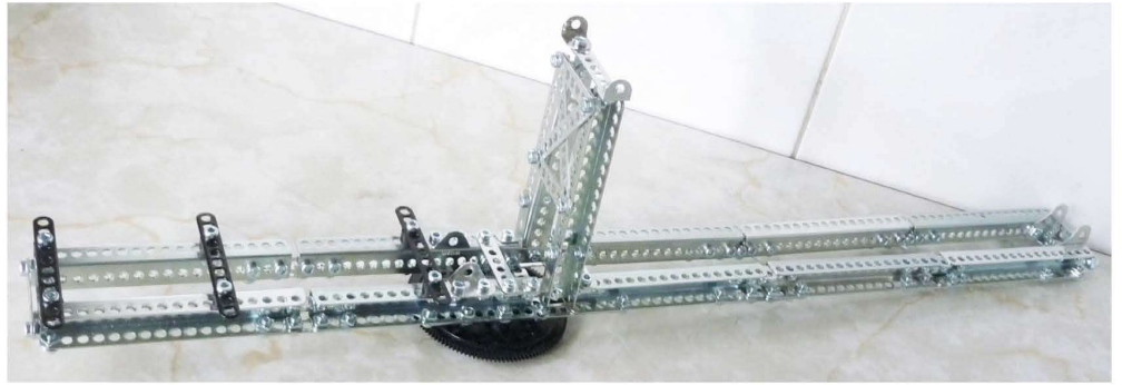
Fig. 6 – La poutre avec son pylône et le chemin de roulement
