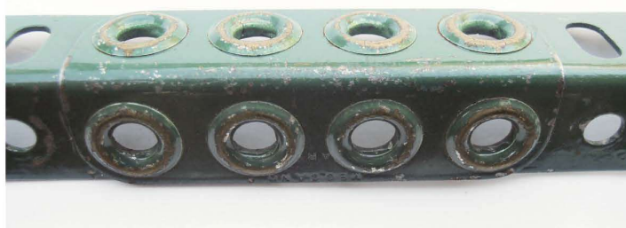
Fig. 3 Gros plan des rivetages, coté extérieur
