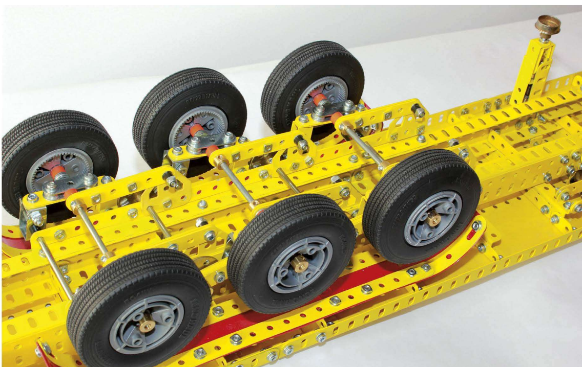
Fig. 10 Les essieux tridem de la remorque et leurs mécanismes de fixation
