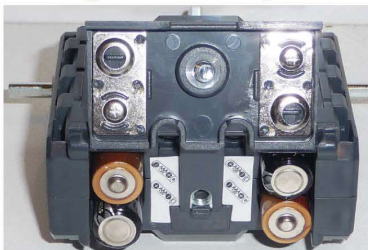
Fig. 5 L'avant - boîtier de piles ouvert
