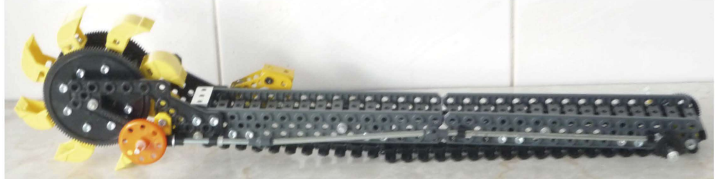
Fig. 10 Entraînement de la roue à godets et le tapis roulant d'extraction
