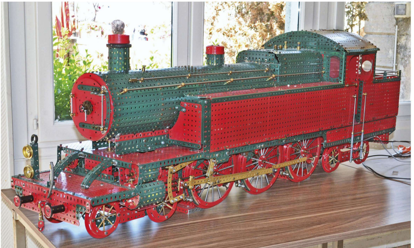
Fig. 12 Exposée à Somberron, la locomotive de type « Baltic » de Jean-René Mercuzot, avec sa distribution système « Walschaërts » et... de vraies roues avec des rayons
