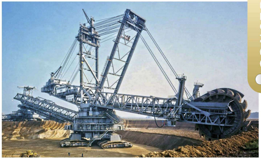
Fig. 1 L'excavatrice à godets Bagger 293
