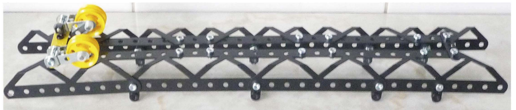
Fig. 11 Le treillis porteur du bras
