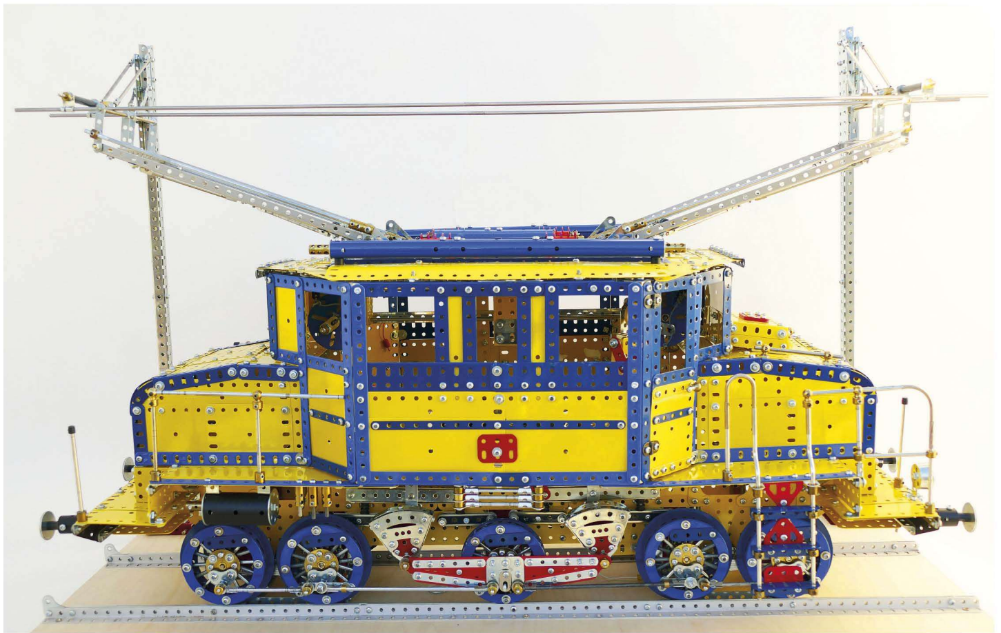
Fig. 1 La loco vue de face avec ses pantographes typiques des locos triphasées italiennes. A noter la roue centrale sans rebord
