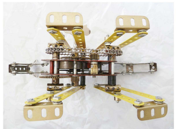
Fig. 4 Le mécanisme vu de dessous, clé insérée
