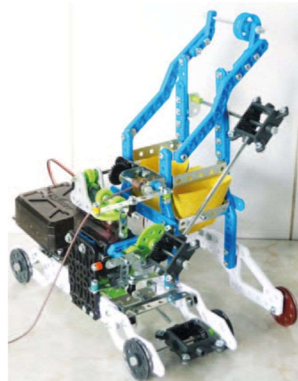
Fig. 5 Le bâti, moteur en place
