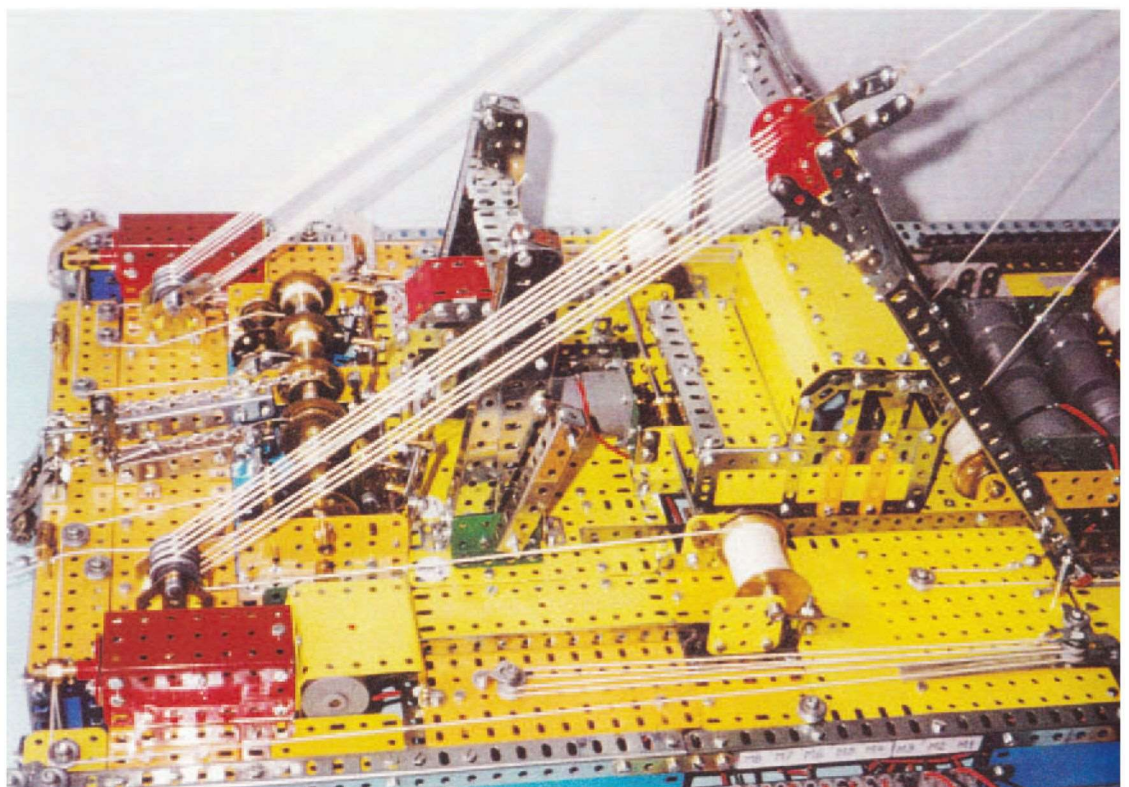
Fig. 5 Treuils de réglage d'inclinaison de la flèche principale. Entre les deux importants mouflages de câble, le système support de la flèche en position « navire »
