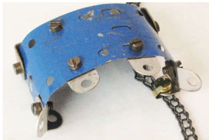
Fig. 19 Fixation d'un godet sur la chaîne
