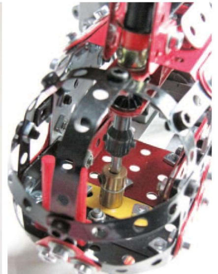
Fig. 4 Intérieur du poste de pilotage avec l'arbre descendant du rotor prolongé par un cardan plastique vers le train avant
