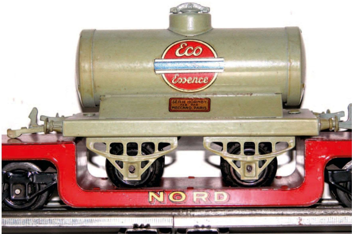
Fig. 6 Les boudins de roues en place avec les attelages relevés. Le châssis et les tampons ne frottent pas sur la tôle du «surbaissé»
