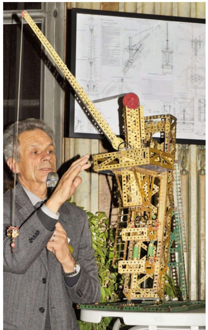
Fig. 7 La grue de 15 t de la Tour Eiffel, réalisée par M. Jannin; il fallait régler la verticalité de la grue et l'horizontalité des plateformes lors du déplacement sur le plan incliné dont la pente variait en permanence
