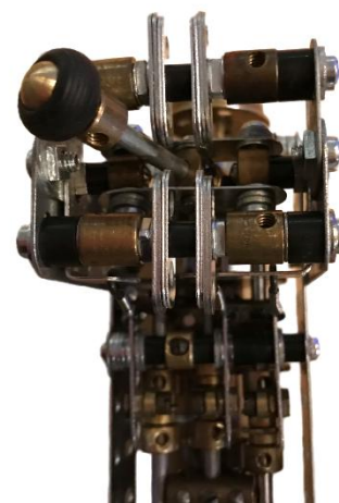
Abb. 19: Schalthebel (Stellung 1. Gang)
