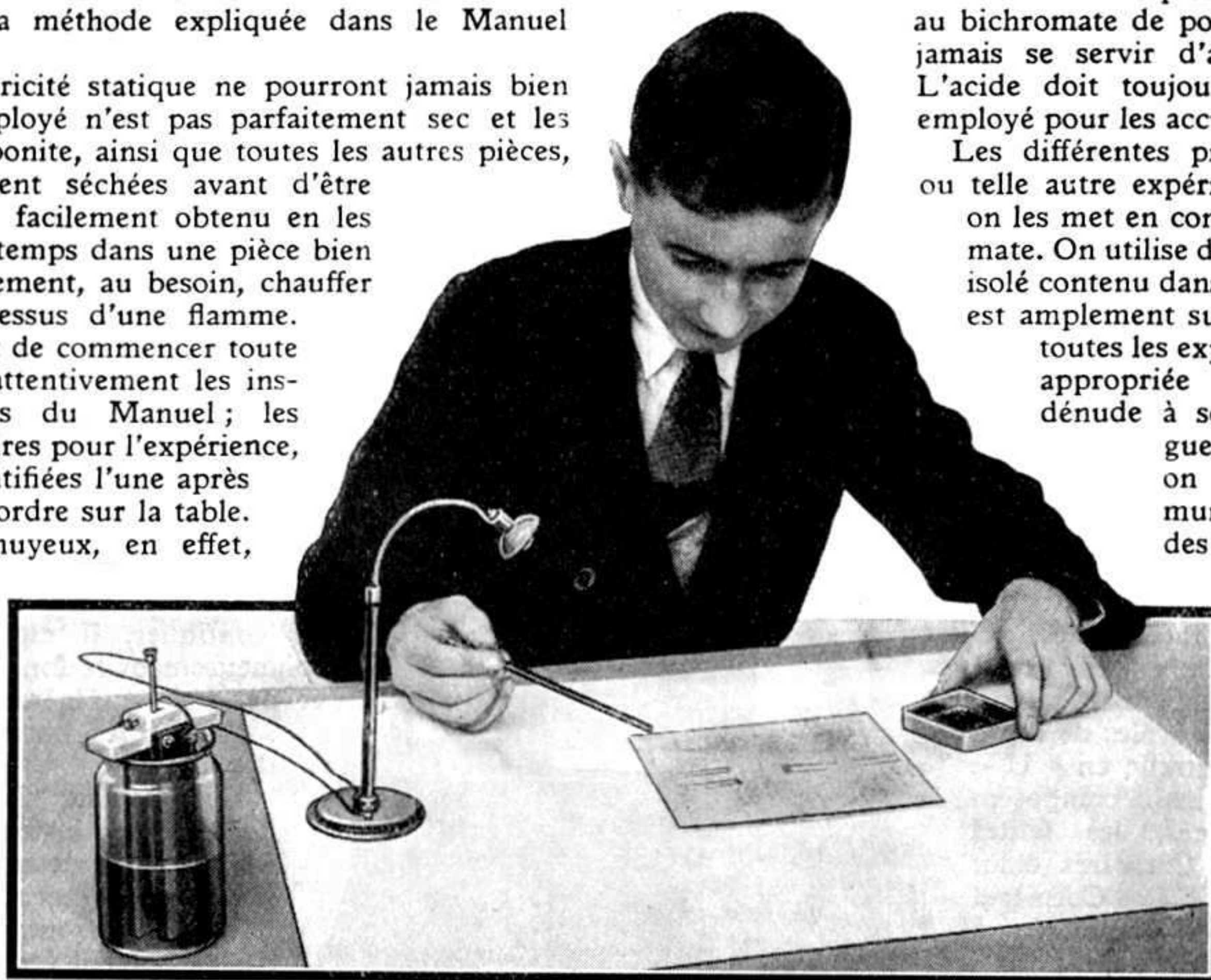
Fig. 3. — Préparation d'un spectre magnétique. On voit la lampe à chevet Elektron à gauche.
