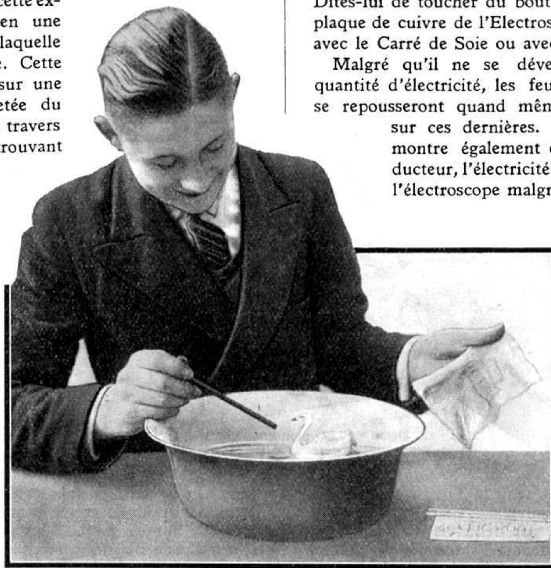
Fig. 3. — Un cygne en cellulose nage dans une cuvette d'eau, attiré par une baguette d'ébonite électrisée. Une baguette de verre électrisée produit exactement le même effet.
