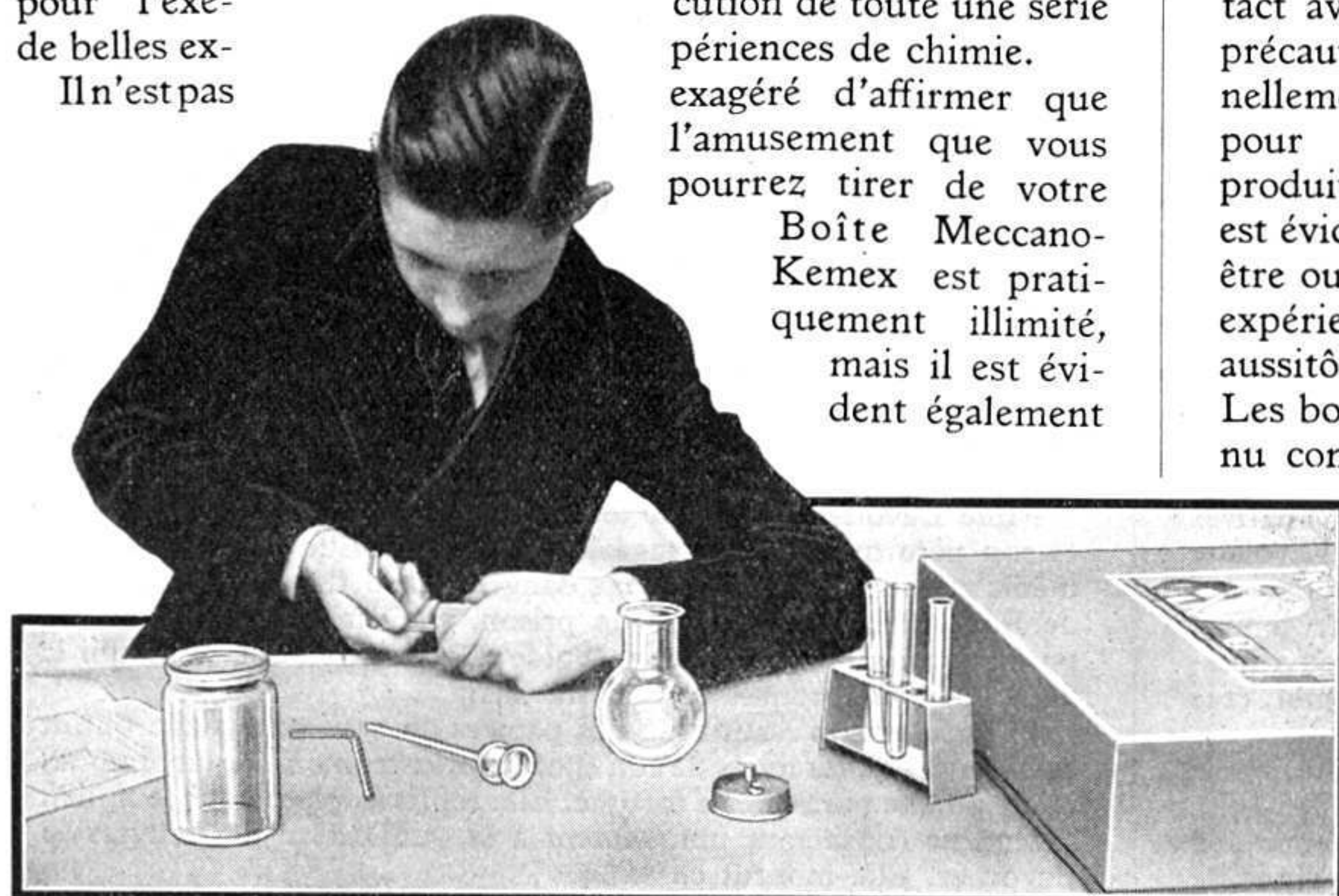
Fig. 2. — L'expérimentateur insérant le petit Tube Coudé à Angle Droit dans un des trous du Bouchon doublement perforé.
