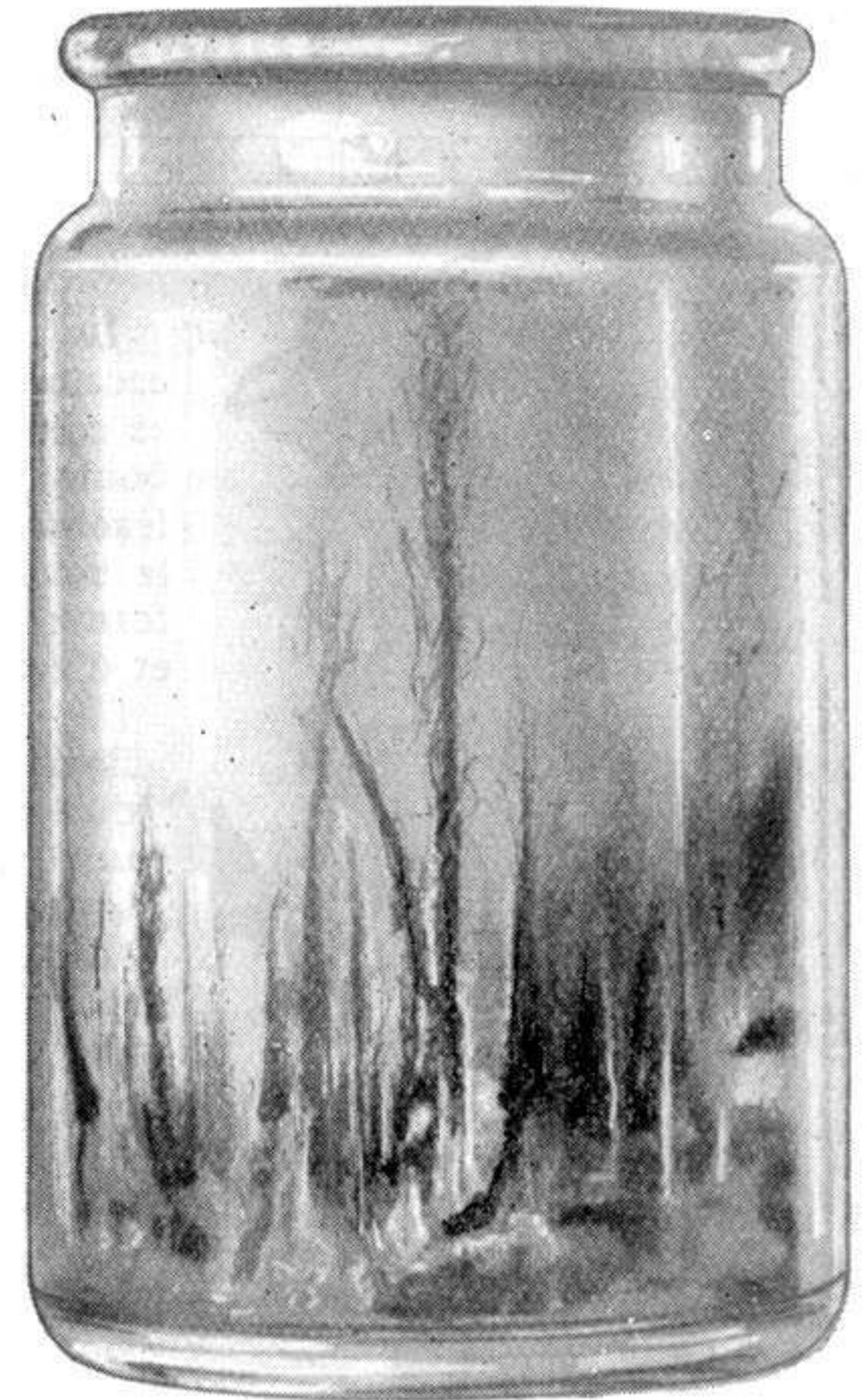
Fig. 3. — « Jardin chimique » dont les « plantes » ont poussé sur des cristaux de Sulfate de Magnésium et d'autres produits chimiques.
