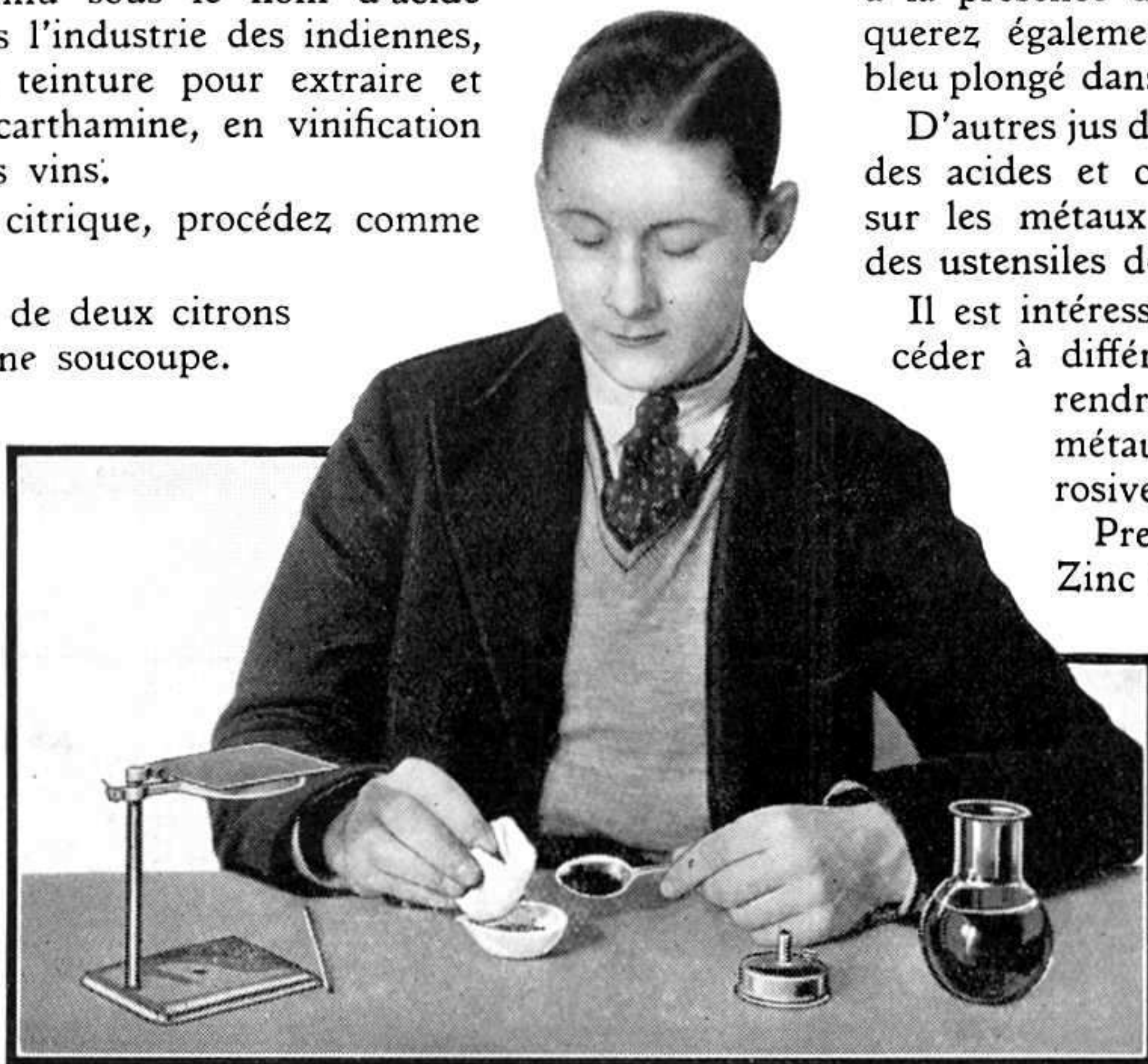
Nettoyez la cuiller en la frottant avec un chiffon préalablement trempé dans de la solution d'ammoniaque...
