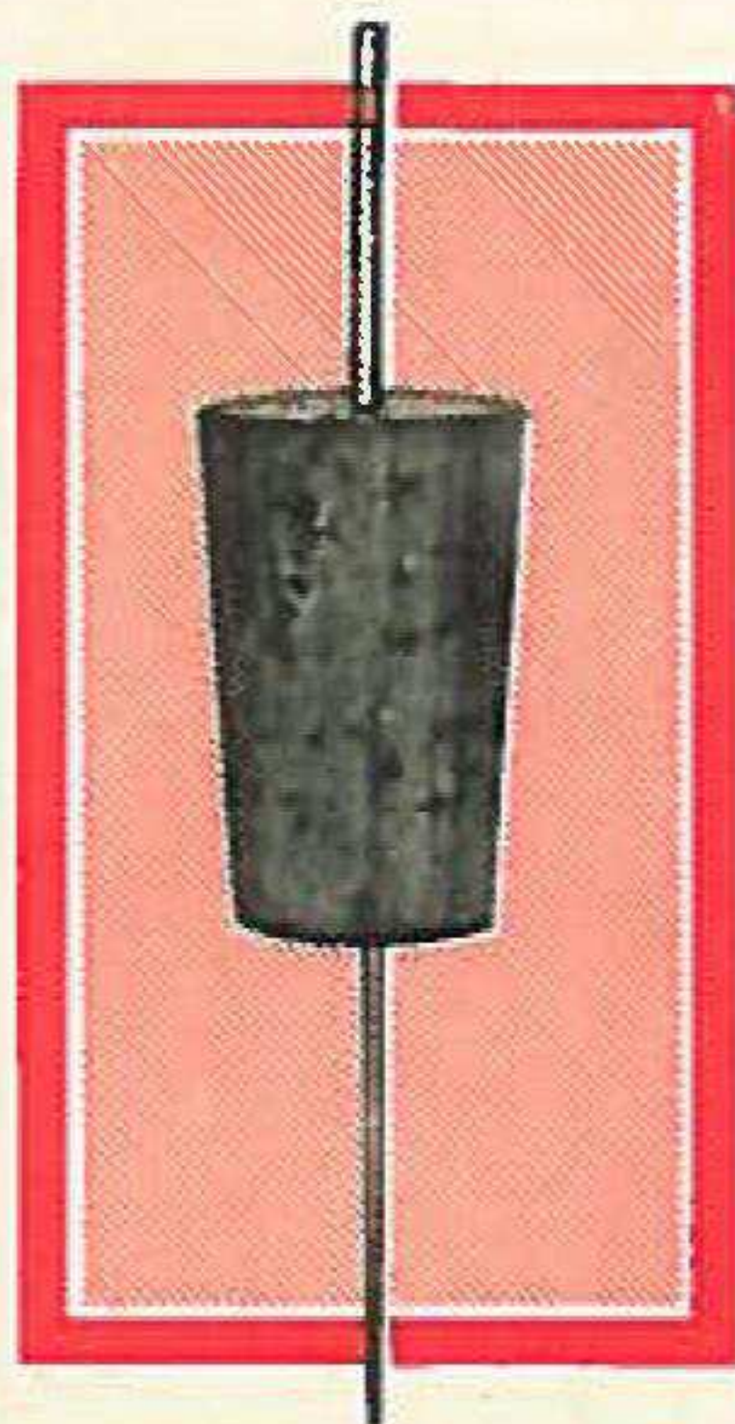
Fig. 22. Aiguille aimantée et bouchon employés pendant les expériences avec l'aimant flottant.
